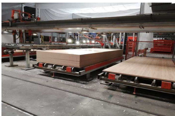
Slika 6. Oplemenjene ploče iverice na kraju linije za oplemenjivanje
