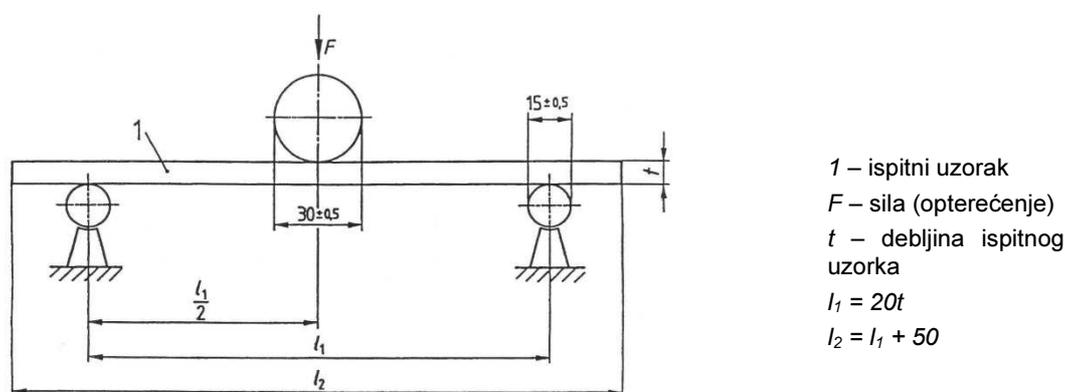
**Slika 8.** Princip ispitivanja i postavke uređaja za ispitivanje savojne čvrstoće
