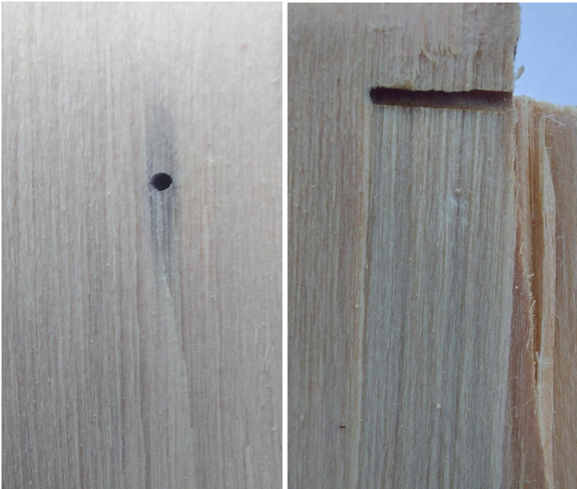
Slika 18: Hodnik s crnim stjenkama i crnim micelijem koji je prorasao u okolno drvo
