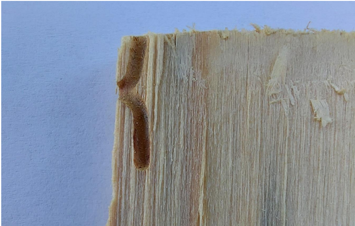
Slika 17: Vertikalni hodnici usmjereni prema gore i dolje na kraju horizontalnog hodnika
