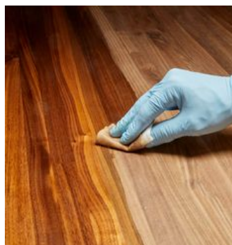
Slika 8. Nanošenje ulja krpom
