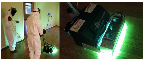
Slika 11. Mobilni uređaj za otvrdnjavanje UV premaza
