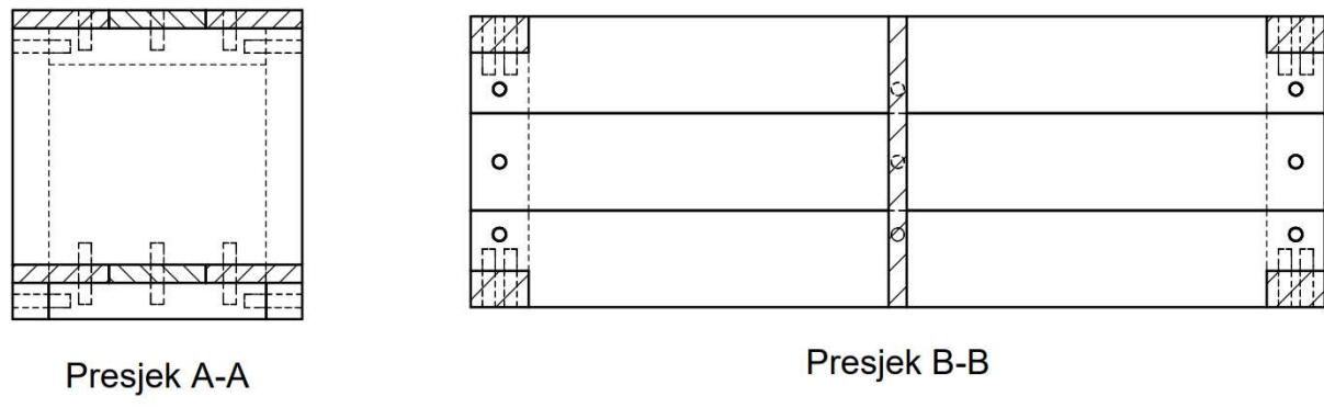
*Slika 15. Prikaz komode u ortogonalnoj projekciji, njegov A-A i B-B presjek*
