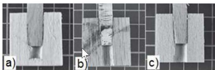
**Slika 3.** Presjek uzorka sa zavarenim moždanikom u smjeru vlakanaca: a) u smrekovinu; b) u hrastovinu; c) u bukovinu (Župčić i dr., 2014)
