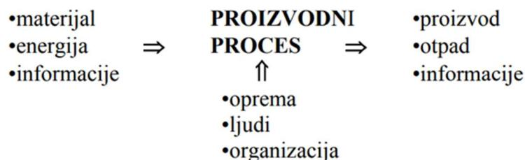
*Slika 1. Ulazni i izlazni elementi proizvodnog procesa (Bogner, 2012)*
