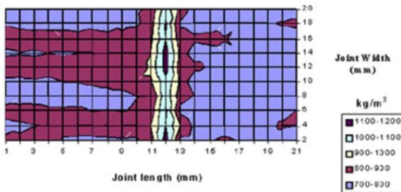
**Slika 4.** Rendgenska mikrodenzimetrijska karta stvarnih vrijednosti gustoće u kg/m<sup>3</sup> dobro linearno vibracijski zavarenog drva bukve (Pizzi i dr., 2003)
