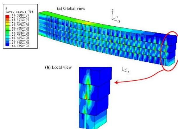
**Slika 8.** 3D prikaz stres analize višeslojne drvene grede spajane rotacijskim zavarivanjem
