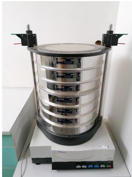
Slika 7. Oscilator za granulometrijsku analizu Retsch AS 400 control
