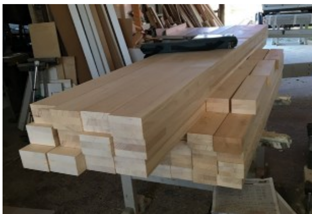
Slika 20. Lamelirani profili (pogon „Stolarije Haus“)
