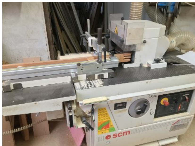
Slika 40. Stolna glodalica namještena za izradu dvostrukog raskola (pogon „Stolarije Haus“)
