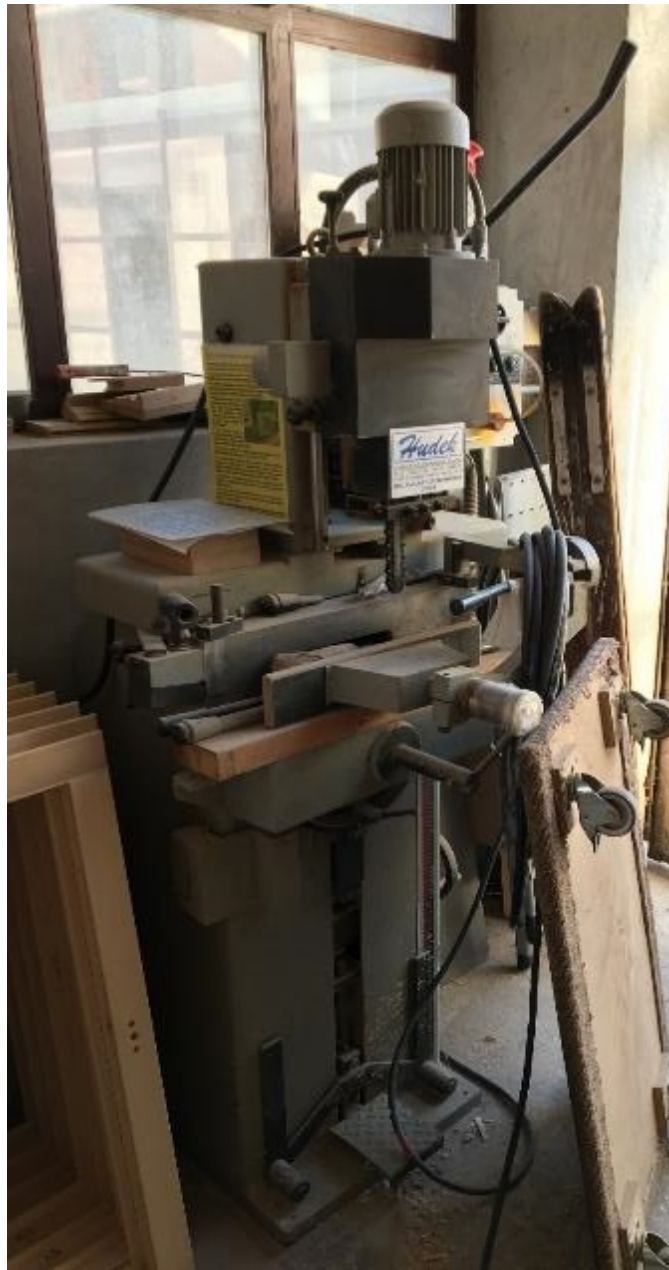
Slika 41. Lančana glodalica (pogon „Stolarije Haus“)
