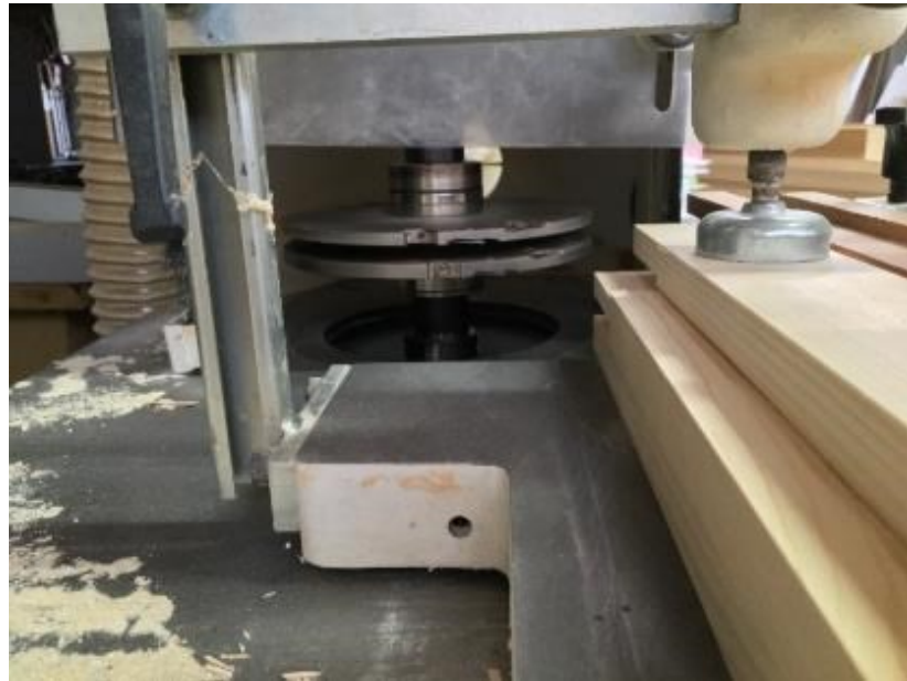
Slika 39. Kombinacija glodala (služi za izradu dvostrukog čepa) (pogon „Stolarije Haus“)
