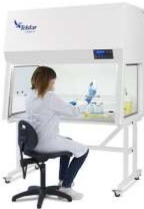
Slika 1. Laminar s horizontalnim strujanjem zraka
