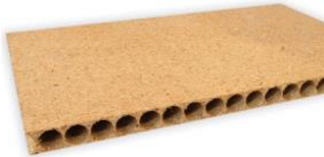
Slika 13 Ploča iverice s okomitim položajem iverja sa šupljinama
