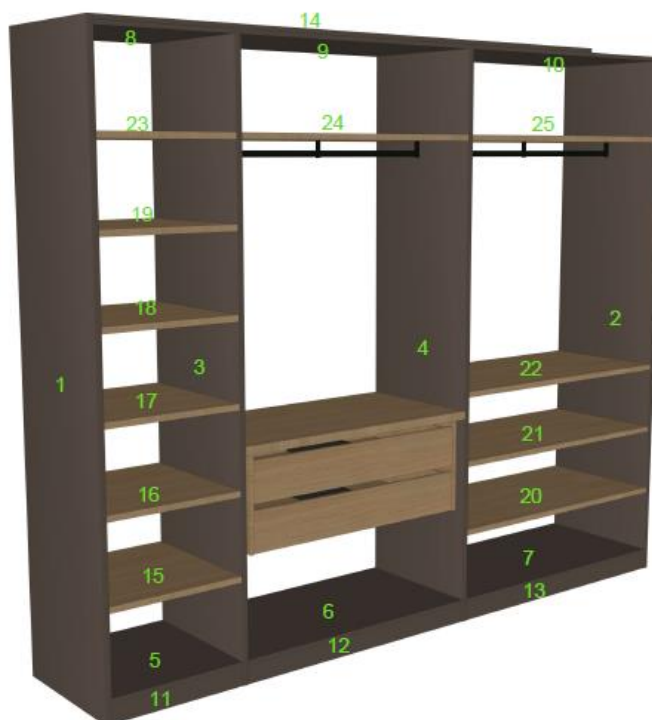
Slika 39 Lijevi ormar dimenzija 3000x600x2500
