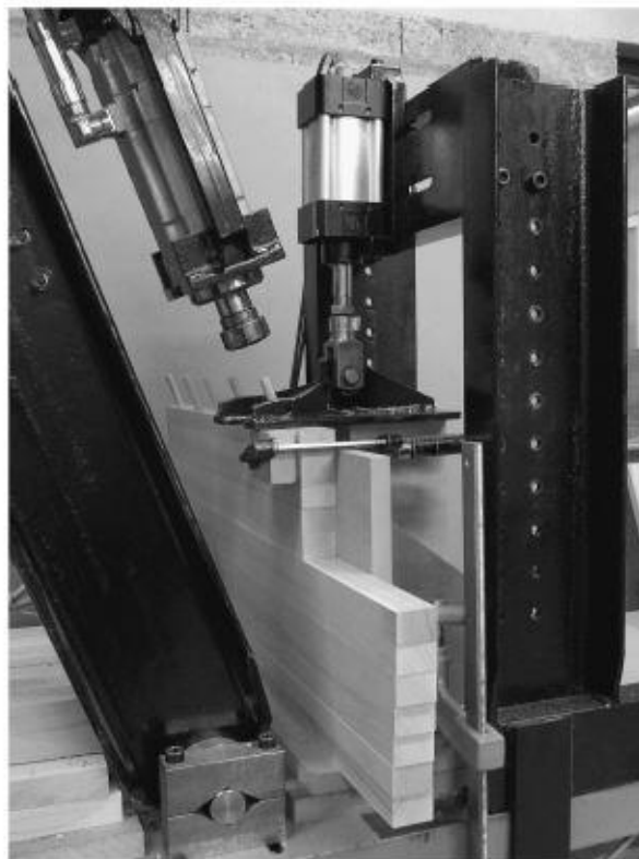
Slika 12. Oprema za zavarivanje moždanika pri nagibu od 20° ( Belleville i dr. 2010)
