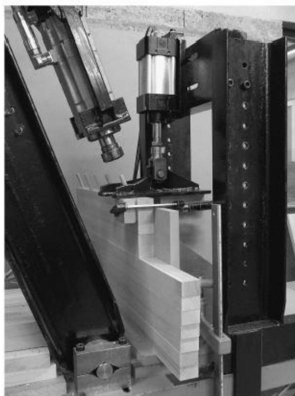
Slika 12. Oprema za zavarivanje moždanika pri nagibu od  $20^\circ$  ( Belleville i dr. 2010)
