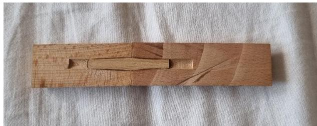
Slika 10. Presjek dužinsko zavarena dva elementa s moždanikom pomoću rotacijskog zavarivanja
