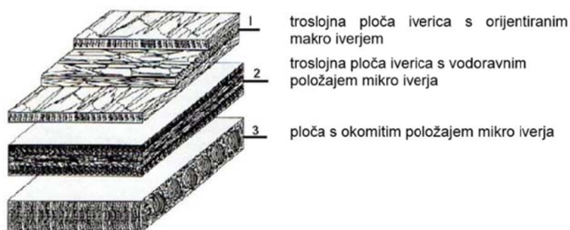
Slika 1. Sheme osnovnih vrsta ploča iverica ( Izvor: Jambreković, 2004 )
