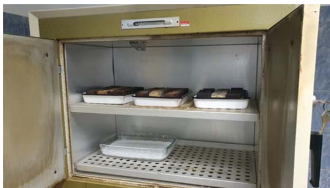
Slika 9. Laboratorijski sušionik s uzorcima (u metalnim posudama) postavljenim na gornju policu
