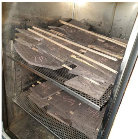
Slika 20. Uzorci abonosa u sušioniku
