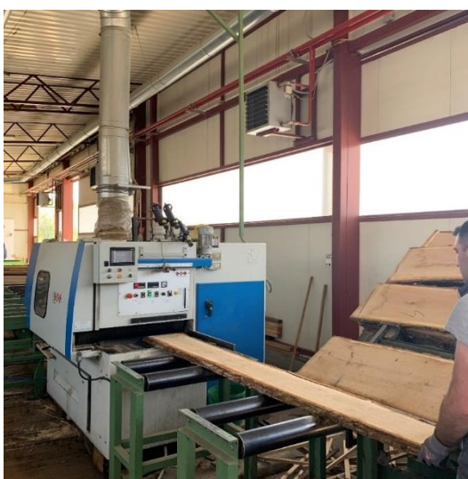
Slika 9. Obrada piljenica recentnog hrasta na višelisnoj kružnoj pili
