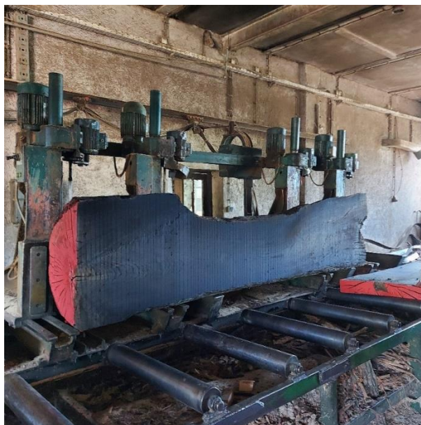
Slika 5. Raspiljivanje trupca abonosa na tračnoj pili trupčari
