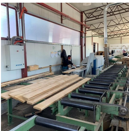
Slika 10. Obrada piljenica recentnog hrasta na optimizeru
