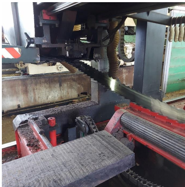
Slika 12. Pila s obostranim nazubljenjem
