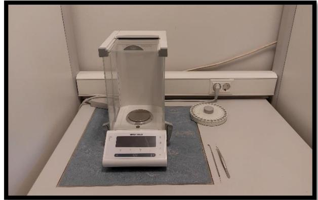
Slika 11. Priprema i odvaga uzoraka za određivanje organskog ugljika i ukupnog dušika
