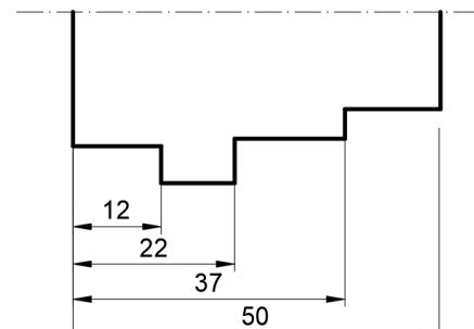
Slika 4.11 Paralelno kotiranje
