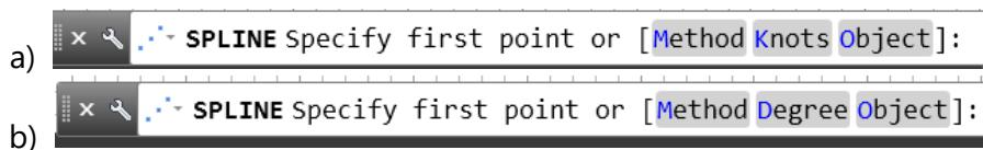
Slika 7.70 Zapovjedne linije za crtanje krivulje *Spline Fit* (a) i *Spline CV* (b)
