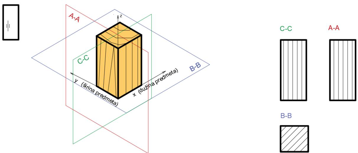
Slika 6.13 Presjene drvene prizme koja ima vlakanca vertikalno u smjeru visine predmeta
