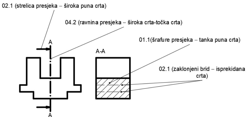
Slika 2.10 Primjena crta za prikaz poprečnoga presjeka drva
