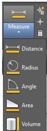
Slika 7.160 Padajući izbornik alata za mjerenje *Measure*
