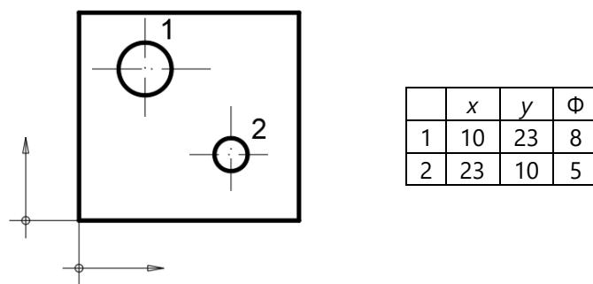
Slika 4.26 Pojednostavljenko koordinatno paralelno kotiranje
