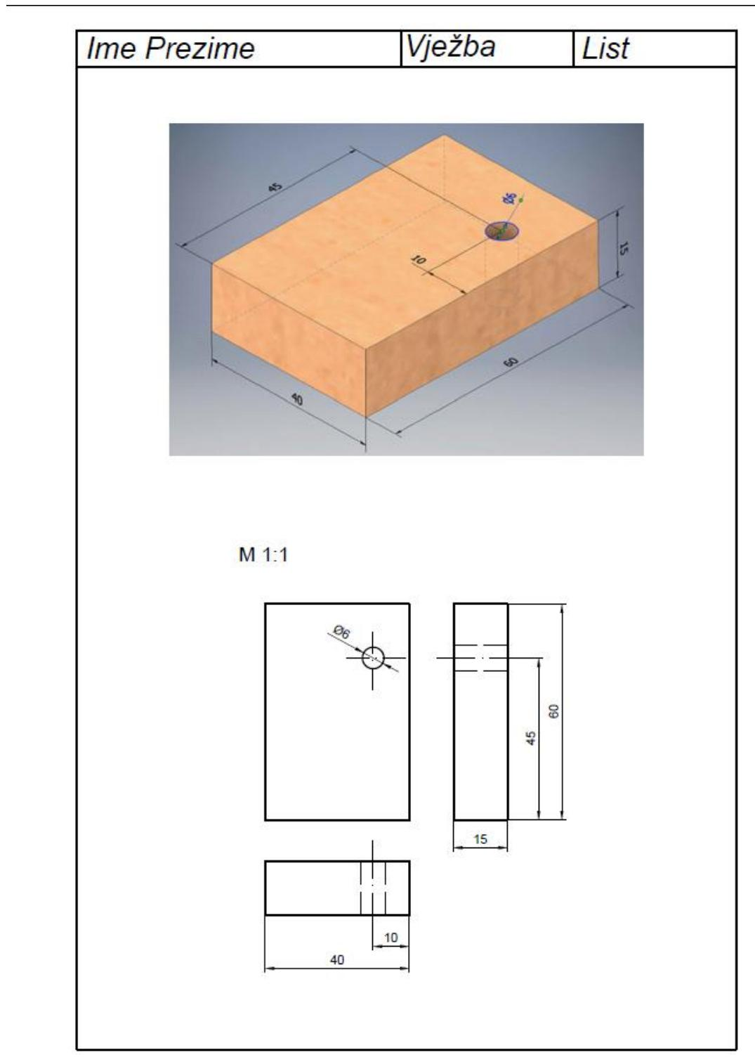
Slika 8.2 Tehnički crtež modela s provrtom
