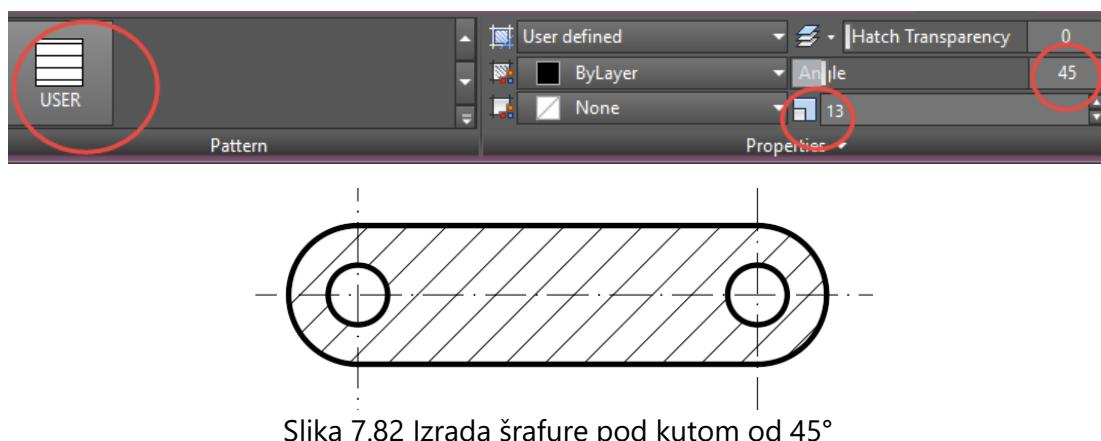
Slika 7.82 Izrada šrafure pod kutom od  $45^\circ$
