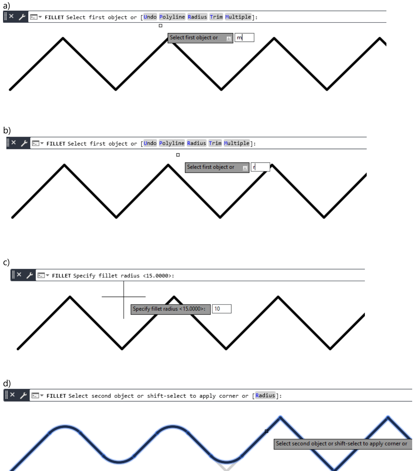
Slika 7.120 Postupak zaobljenja većega broja pravaca
