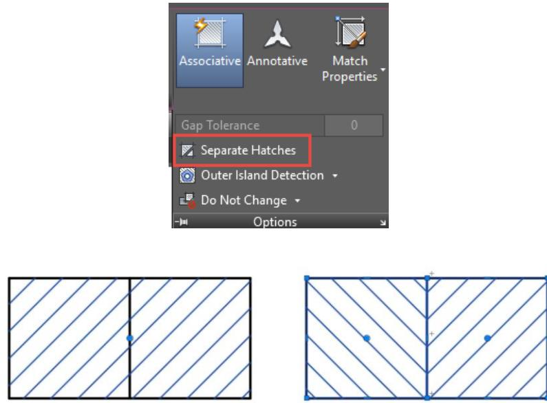
Slika 7.85 Izrada razdvojenih šrafura (*Separate Hatches*)
