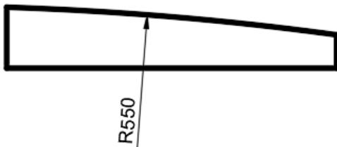
Slika 4.17 Kotiranje polumjera kružnih lukova blage zakrivljenosti
