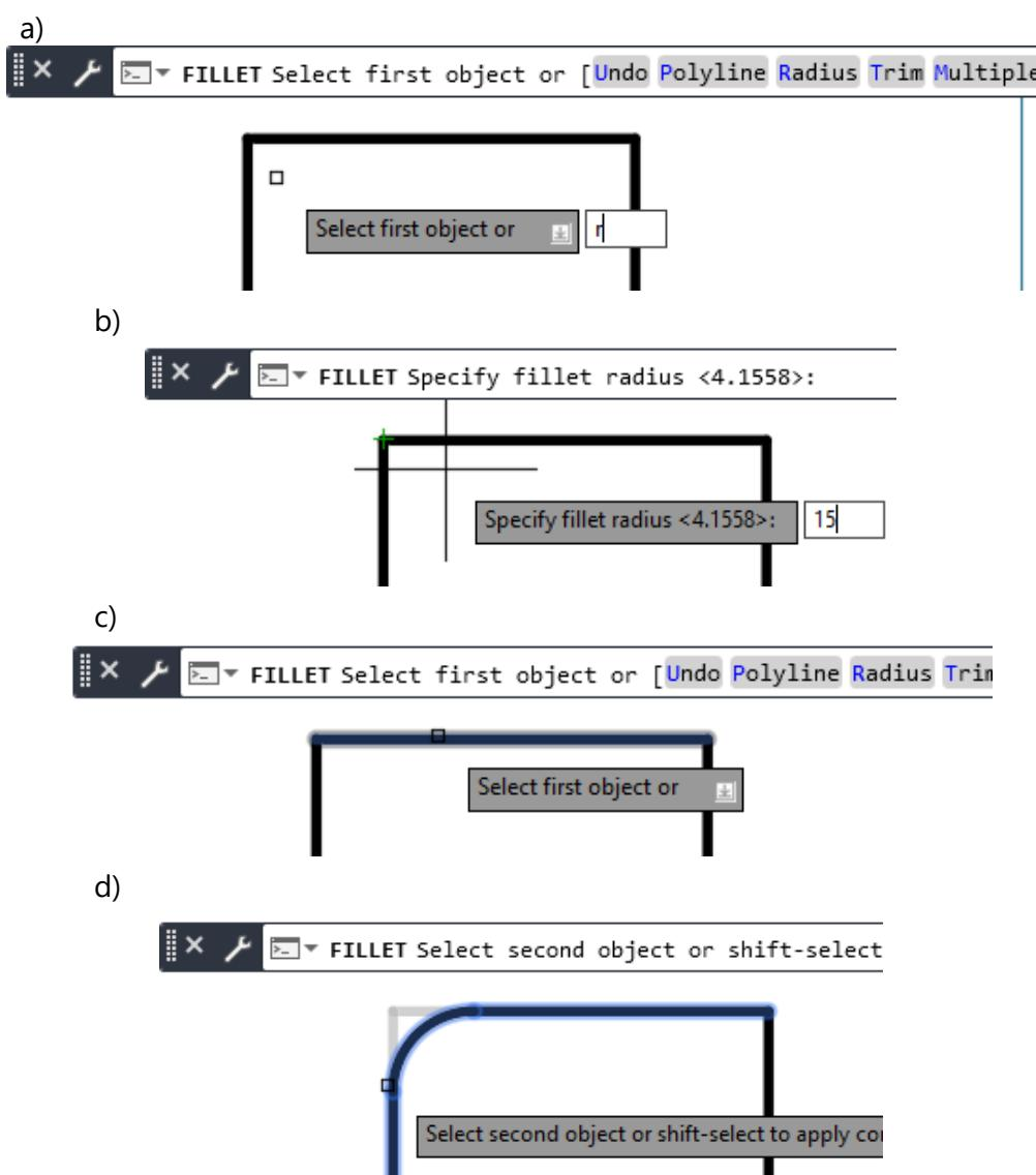
Slika 7.118 Postupak zaobljenje kuta alatom *Fillet*
