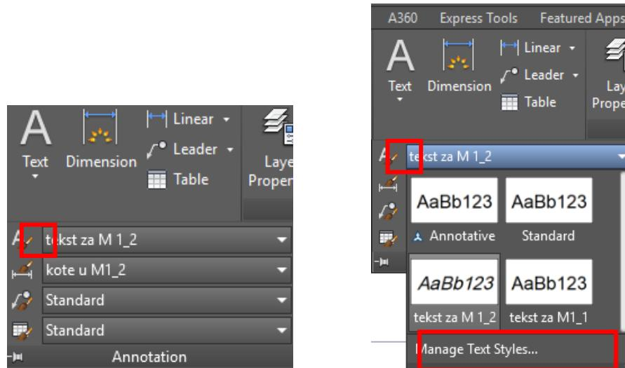
Slika 7.19 Padajući izbornik za otvaranje dijaloškoga okvira *Manage Text Styles*
