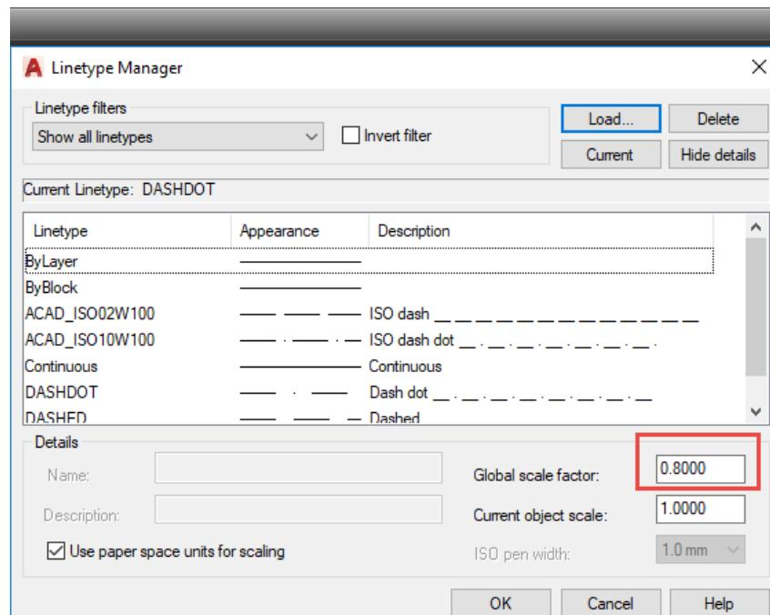
Slika 7.18 Dijaloški okvir za uređivanje izgleda isprekidanih crta
