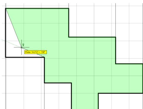
Slika 7.162 Mjerenje površine objekta alatom *Area*
