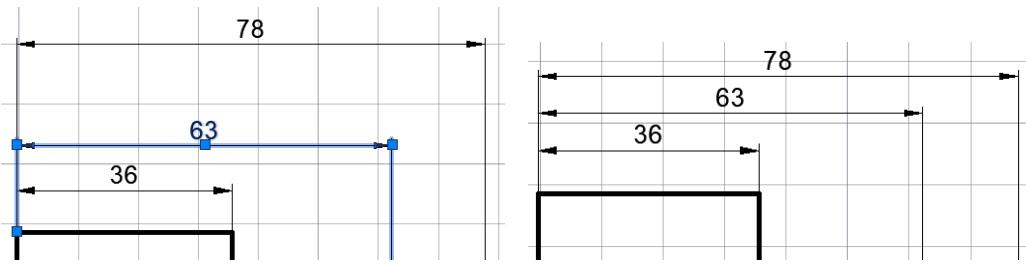
Slika 7.159 Poravnavanje paralelnih kota alatom *Adjust Space*
