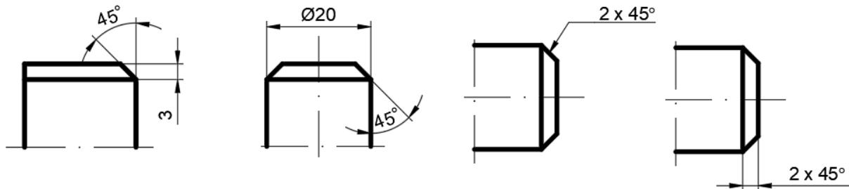
Slika 4.22 Kotiranje skošenih rubova i skošenja (kut  $45^\circ$ )
