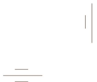
Slika 6.4 Oznaka smjera vlakanaca drva (horizontalno, vertikalno)
