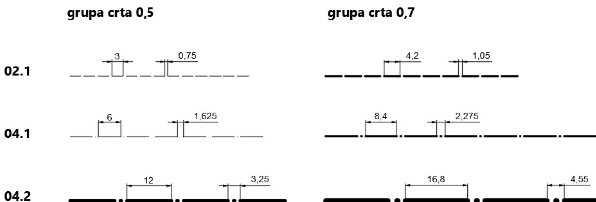
Slika 2.6 Dimenzijske vrijednosti prekinutih i punih dijelova isprekidane (02.1), tanke crta-točka crte (04.1) i široke crta-točka crte (04.2)
