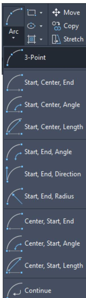
Slika 7.61 Padajući izbornik za crtanje kružnoga luka (*Arc*)
