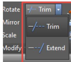
Slika 7.107 Padajući izbornik za odabir alata za skraćivanje
