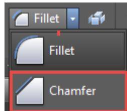
Slika 7.121 Odabir alata za skošenje kuta *Chamfer*
