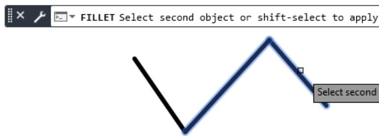
Slika 7.119 Postupak spajanja pravaca alatom zaobljenja *Fillet*
