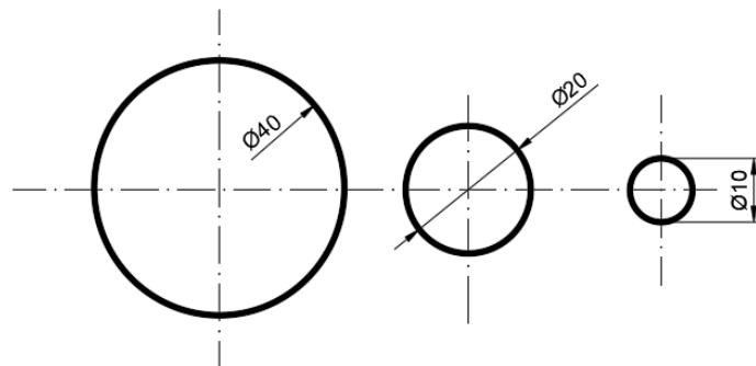
Slika 4.14 Kotiranje promjera
