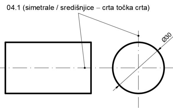
Slika 2.9 Primjena simetrale odnosno središnjice u ortogonalnoj projekciji simetričnih (cilindričnih) predmeta
