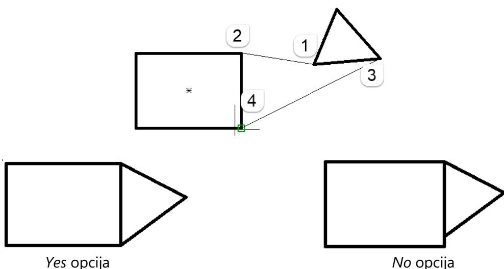
Slika 7.148 Primjena alata *Align* primjenom dviju točaka poravnava
