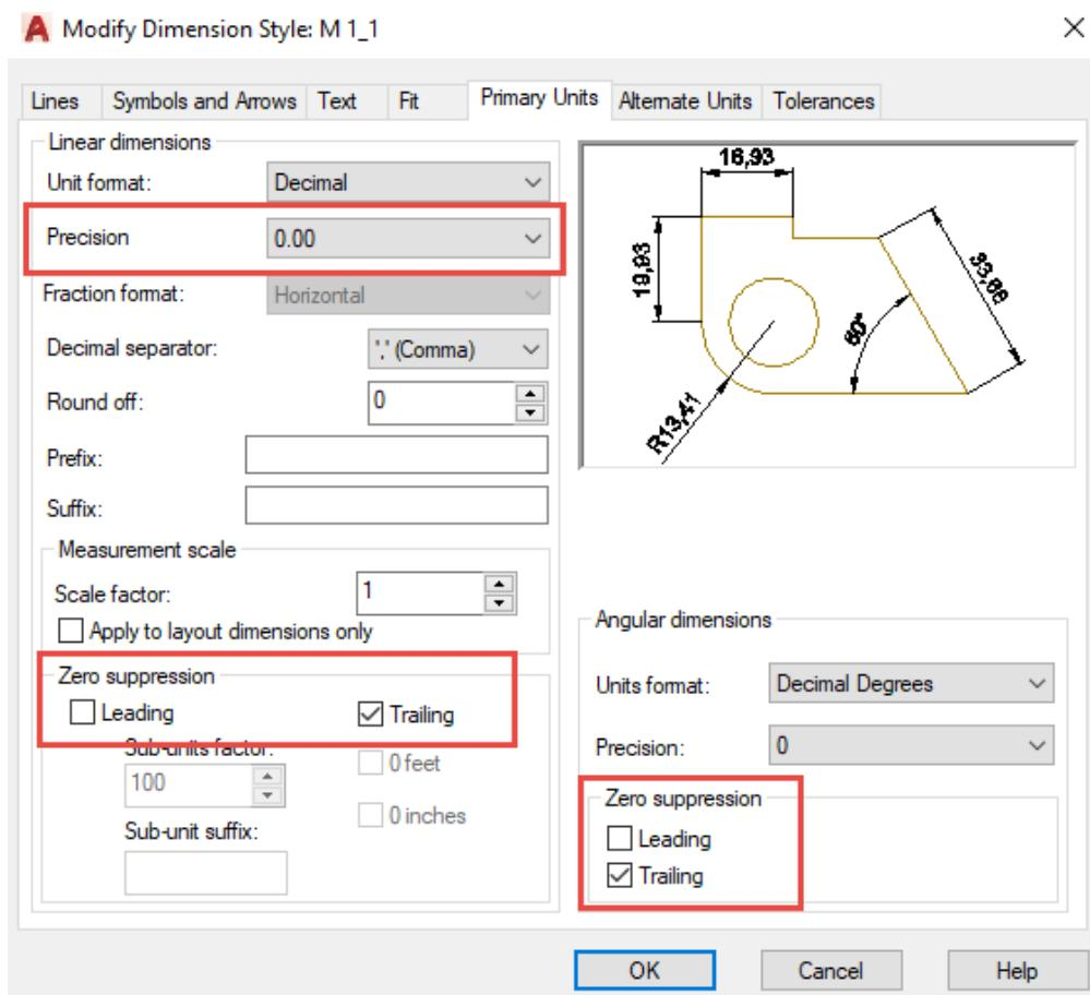
Slika 7.30 Dijaloški okvir za uređivanje prikaza kotnih brojeva
