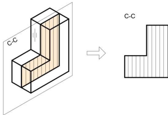
Slika 6.10 Projekcija nacrtnoga presjeka C-C
