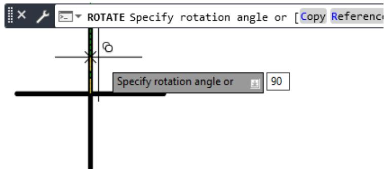
Slika 7.106 Zakretanje objekta opcijom *Copy* alata *Rotate*
