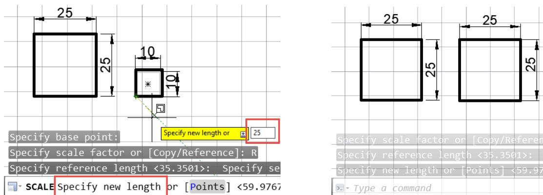
Slika 7.132 Postupak proporcionalnoga povećanja do poznate dimenzije
