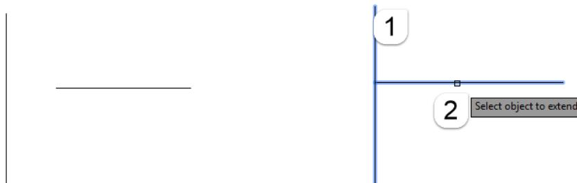
Slika 7.109 Produljivanje crte alatom *Extend*
