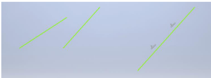
Slika 3.47 Postavljanje dviju crta na isti pravac primjenom geometrijskoga ograničenja Collinear
