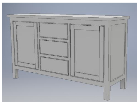
Slika 7.29 Strop komode izrađen ekstruzijom
