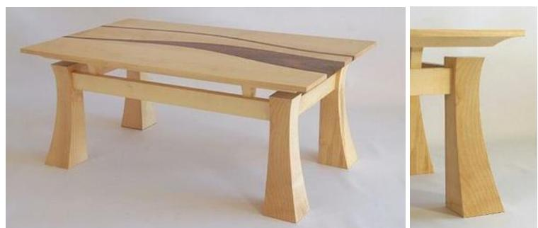
Slika 4.54 Glodana noga stolića promjenjivih dimenzija četvrtasta presjeka
