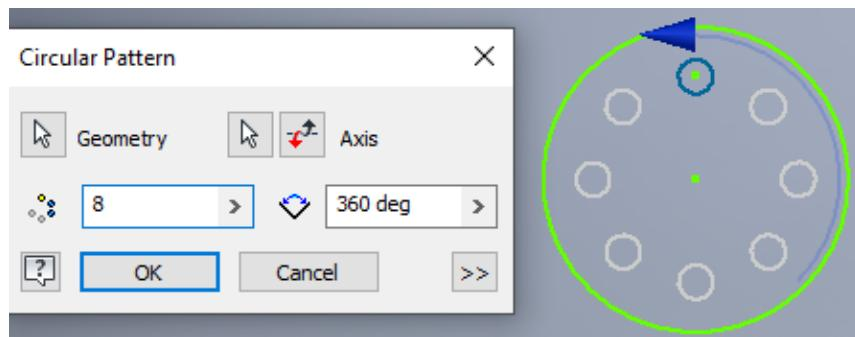
Slika 3.39 Postupak kopiranja i kružnoga nizanja kružnice
