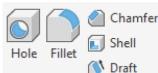
Slika 4.67 Osnovne naredbe alatne trake za uređivanje modela (*Modify*)
