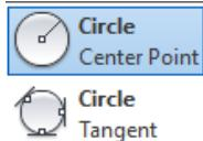
Naredba *Circle* služi za crtanje kružnice iz središta (*Center Point*) ili izborom triju crta koje će biti tangente kružnice (*Tangent*). Kružnica se može crtati proizvoljno ili joj se može odmah zadati promjer, pri čemu će se automatski stvoriti kota s dimenzijom promjera (slika 3.10). Za crtanje kružnice s tri tangente prethodno je potrebno imati nacrtane tri crte koje se odabiru za tangente (slika 3.11).
