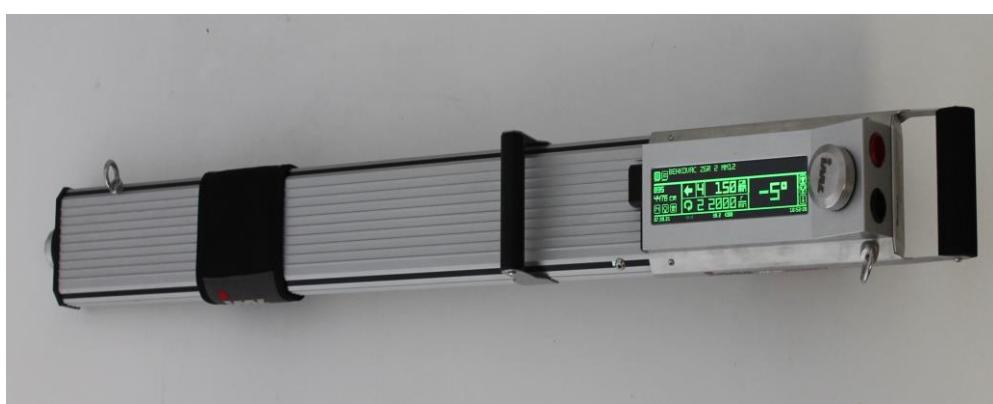
Slika 4. Rezistograf Resi PD500
