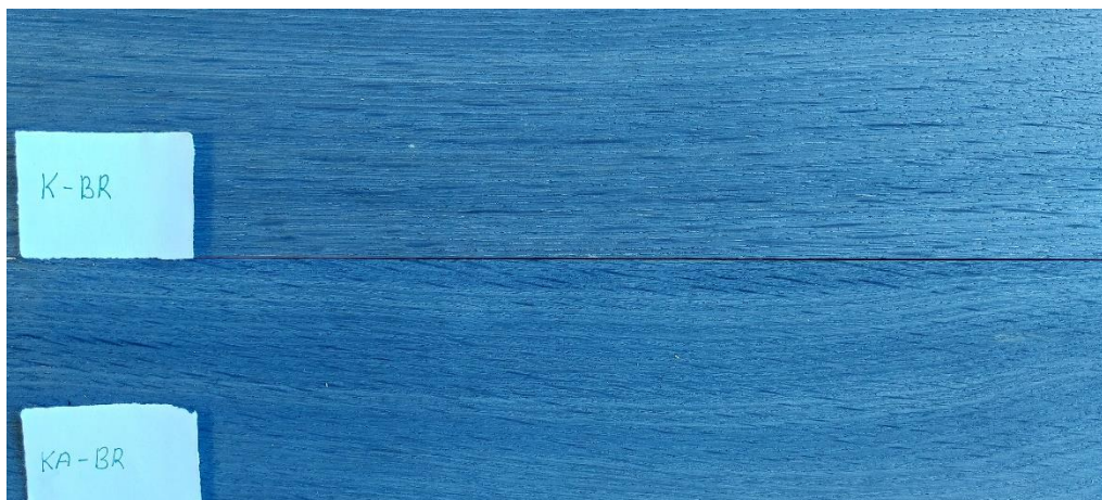
Slika 26. Izgled brušene površine hrasta premazanog kemijskim močilom (K) i kemijskim močilom s dodatkom amonijevog hidroksida (KA)
