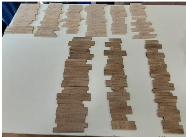
Slika 16. Pripremljeni uzorci za mjerenje dubine penetracije prema vrsti drva i površinskoj obradi
