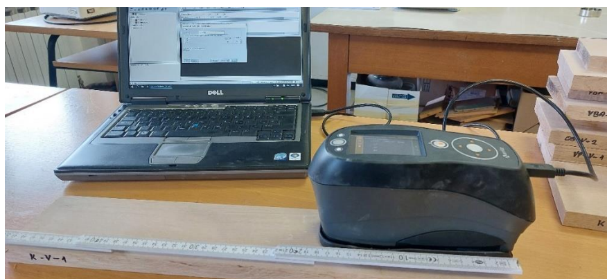
Slika 9. Mjerenje svjetline spektrofotometrom
