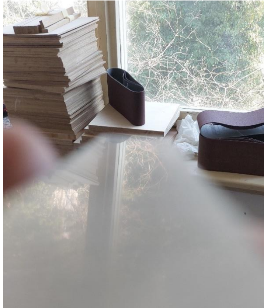
Slika 15. Izgled površine nakon brušenja granulacijom P1500
