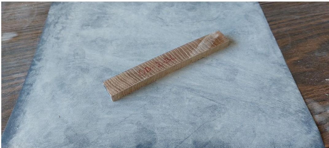
Slika 14. Ručno brušenje uzoraka za mikroskop
