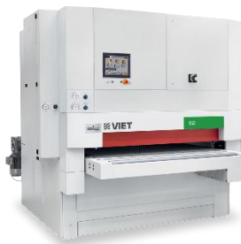
Slika 4. Širokotračna brusilica VIET S2
