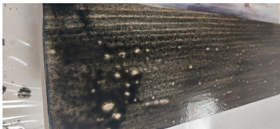
Slika 27. Razdvajanje močila na površini jelovine prilikom nanošenja
