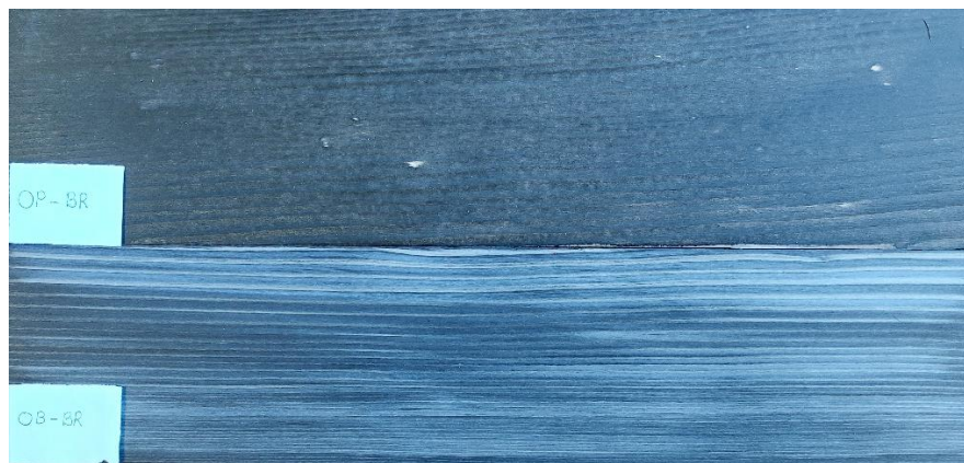
Slika 28. Izgled otapalnog močila s pigmentima (OP) i otapalnog močila s bojilima (OB) na bušenoj jelovini
