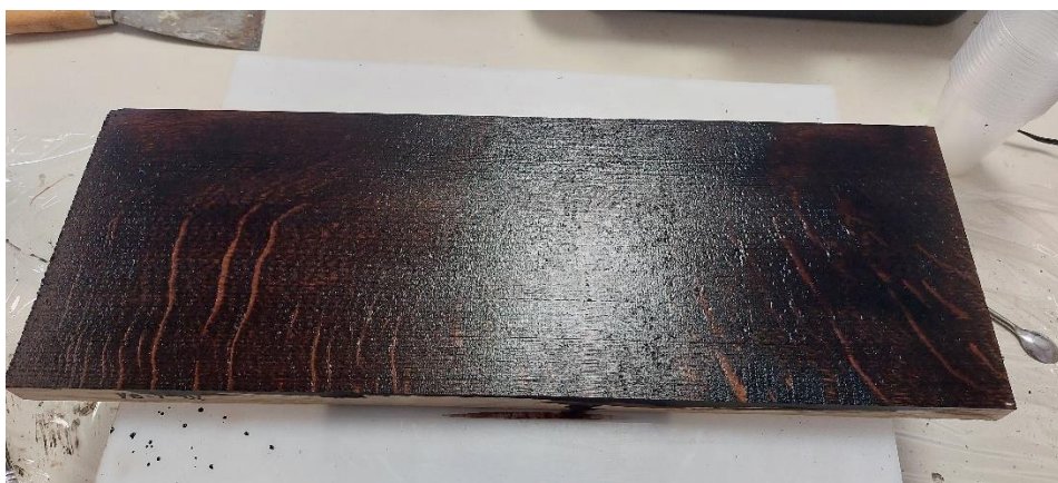
Slika 8. Uzorak nakon nanošenja močila
