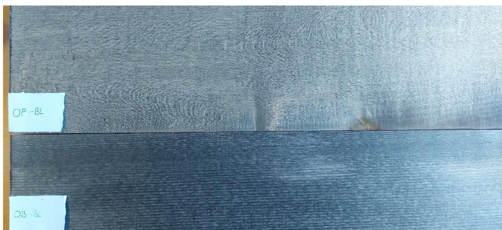
Slika 31. Otapalno močilo s pigmentima (OP) i otapalno močilo s bojilima (OB) na blanjanjoj površini lipe
