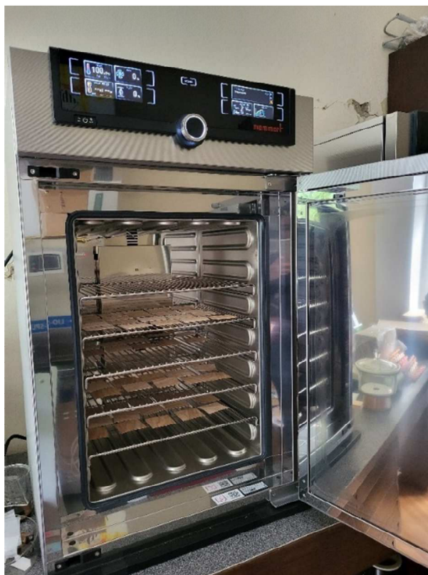
Slika 17. Sušionik sa uzorcima furnira (foto: Ivanda, A., 2022.)
