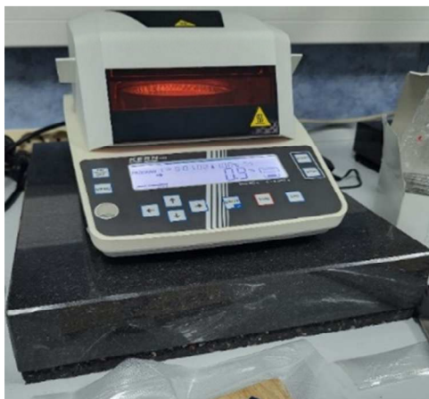
Slika 15. Halogeni vlagomjer u procesu određivanja sadržaja vode uzorka bočnice (foto: Ivanda, A., 2022.)
