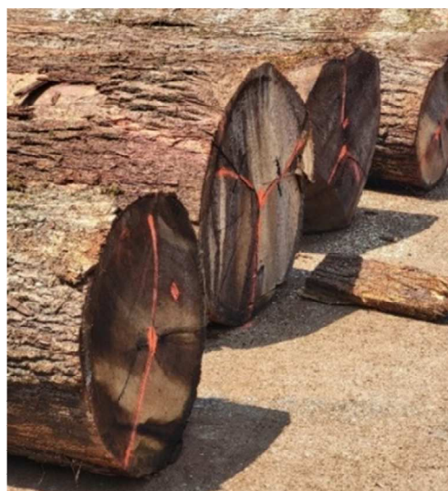
Slika 5. Poprečni presjek trupca označen za daljnje rezanje (foto: Ivanda, A., 2022.)
