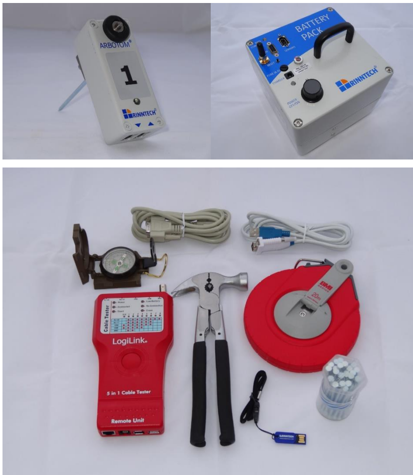
Slika 8 Prikaz dijelova tomografa
