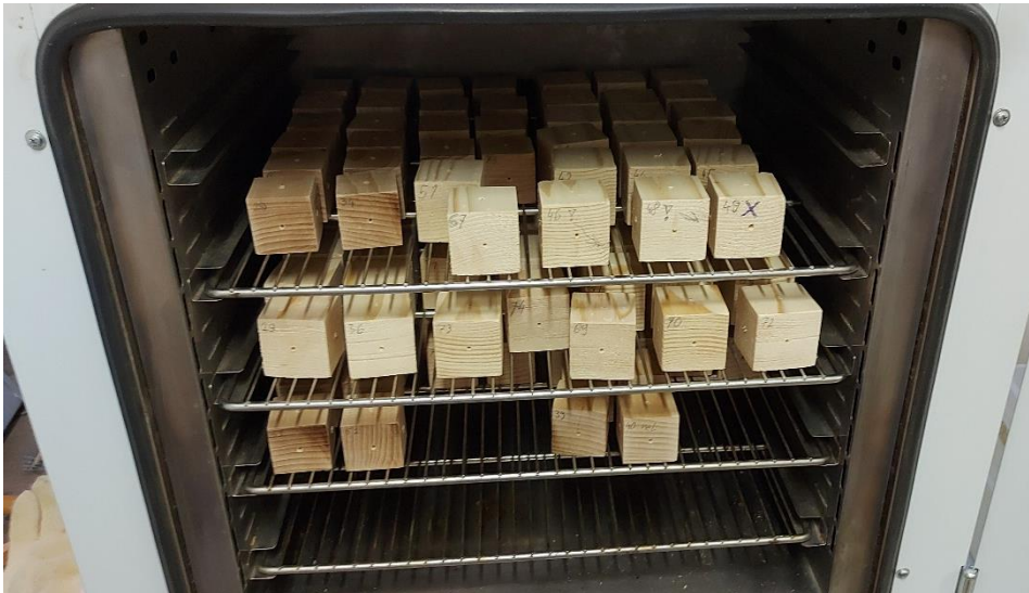
Slika 7. Sušionik s uzorcima
