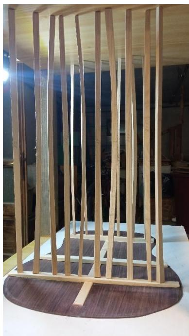
**Slika 29.** Lijepljenje elemenata ukrute na stražnju ploču gitare
