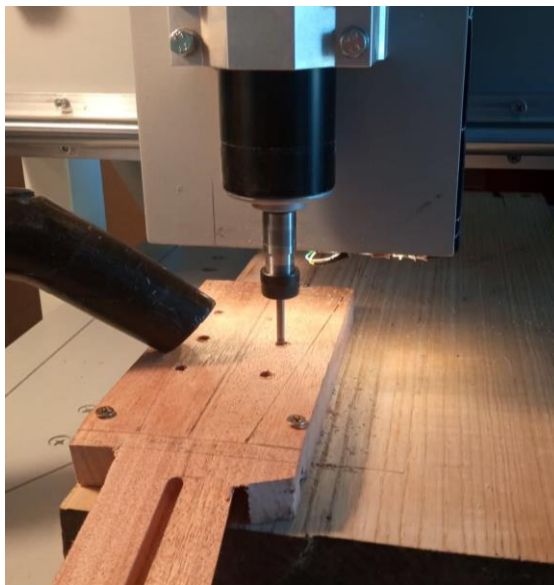
Slika 34. CNC bušenje rupa na glavi gitare
