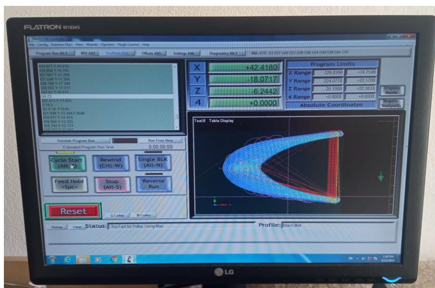
Slika 33. Prikaz ekrana post procesor programa „Mach 3“ u izradi elementa
