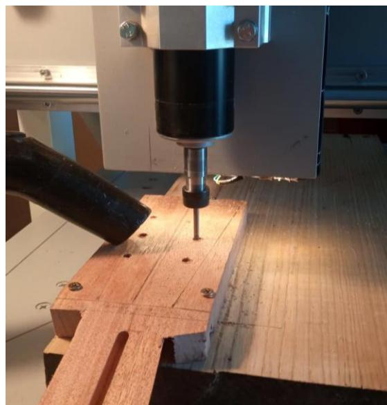
**Slika 34.** CNC bušenje rupa na glavi gitare
