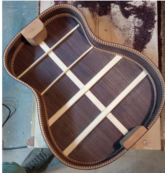
Slika 38. Sklopljena stražnja stranica gitare sa bočnim stranicama
