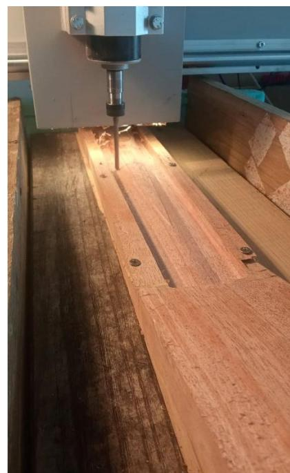
**Slika 31.** CNC obrada vrata gitare
