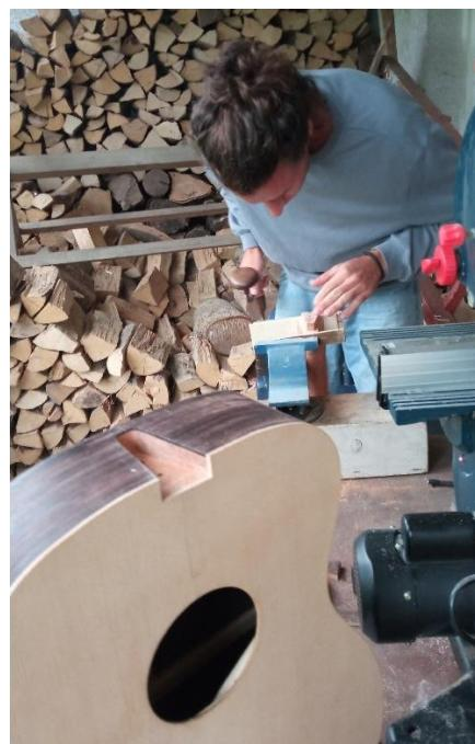
**Slika 39.** Izrada dosjeda vrata gitare s tijelom
