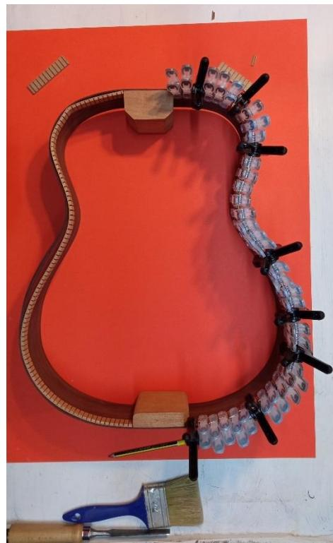
**Slika 27.** Lijepljenje savitljive drvene trake na bočne stranice nakon njihovog sastavljanja
