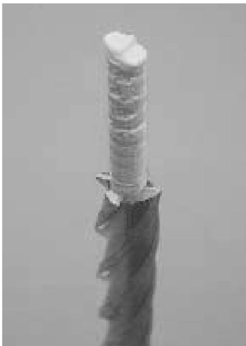
Slika 8. Svrđlo za uzimanje uzoraka (Kasal, 2003.), vanjski promjer 9,5mm, unutarnji promjer 5mm
