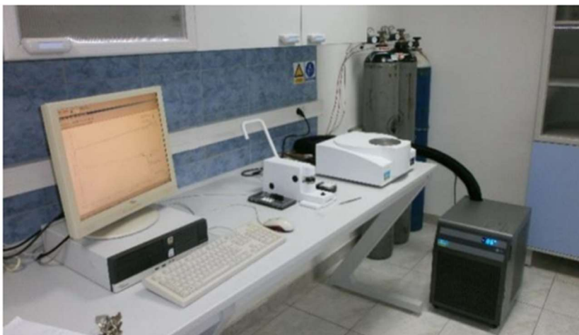
Slika 10. DSC uređaj Perkin Elmer, DSC 6000
