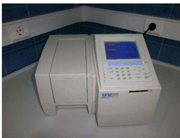
Slika 9. UV-Vis spektrofotometar Shimadzu UV mini-1240
