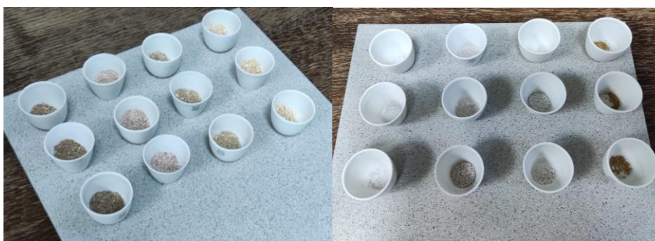
Slika 19. Uzorci prije (lijevo) i nakon (desno) spaljivanja
