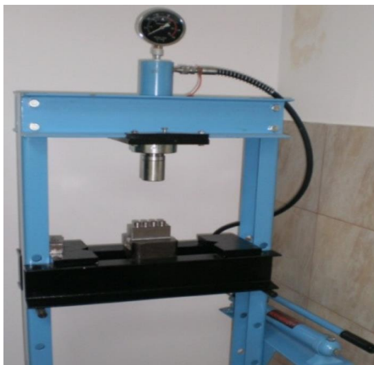
Slika 20. Hidraulična preša sa kalupom za izradu tableta (Augustinović, 2015)
