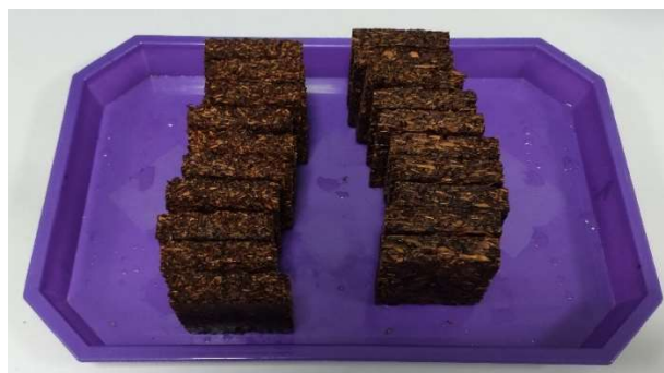
Slika 22. Ocijeđeni uzorci nakon potapanja u vodi
