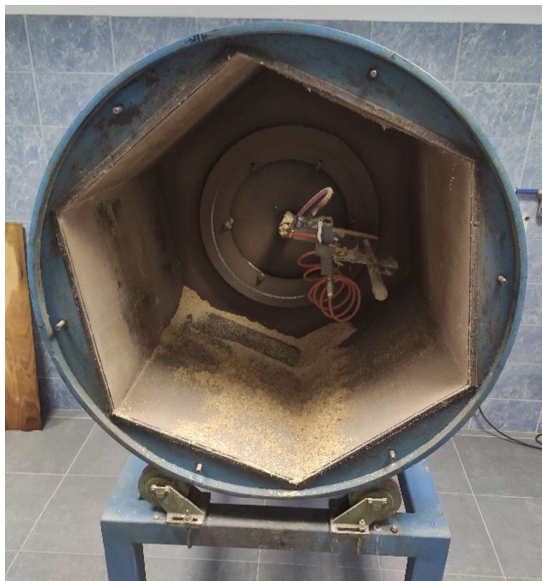
Slika 15. Rotirajući bubanj za oblijepljivanje iverja
