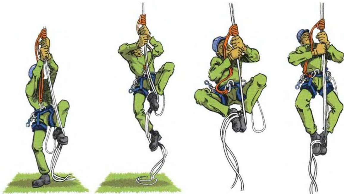
Slika 14. Footlock tehnika (Preuzeto iz: Lilly 2005).
