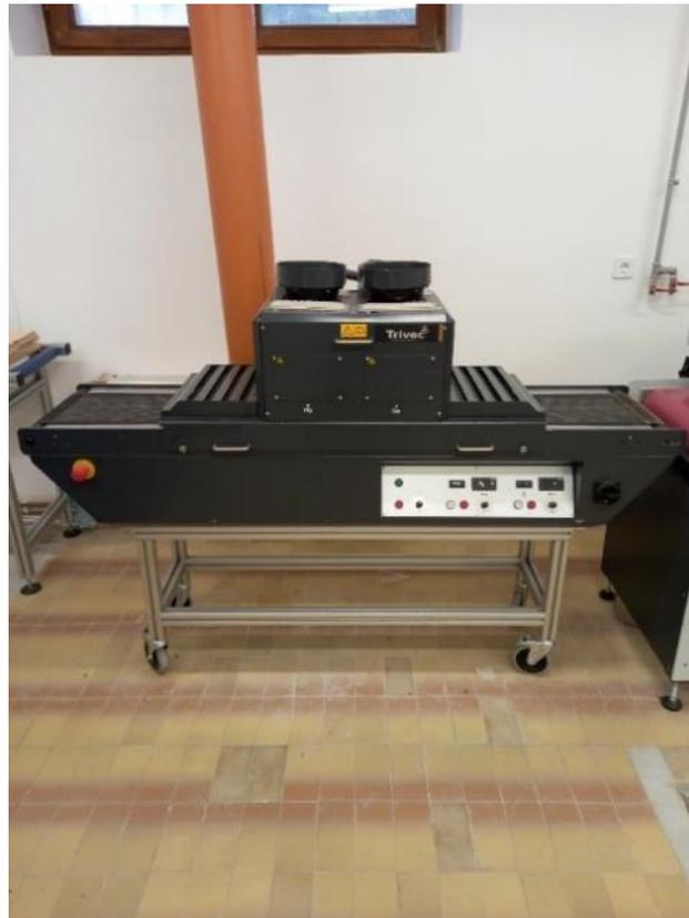
*Slika 6. Uređaj za UV sušenje i otvrdnjavanje lakova*
