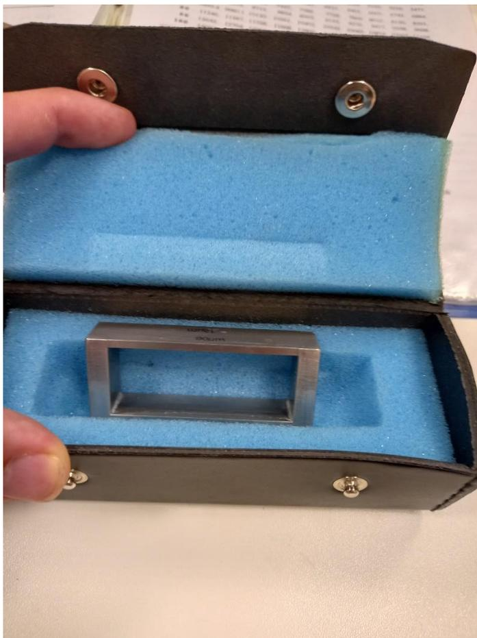
*Slika 12. Kvadrantni profil za ravnomjerno nanošenje laka*
