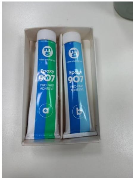
*Slika 13. A i B komponenta epoksidnog ljepila*
