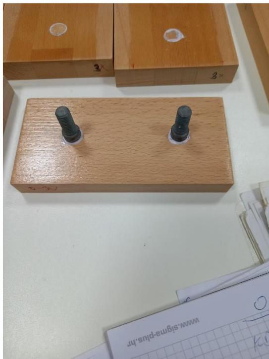
*Slika 17. Lijepljenje valjčića na probe*
