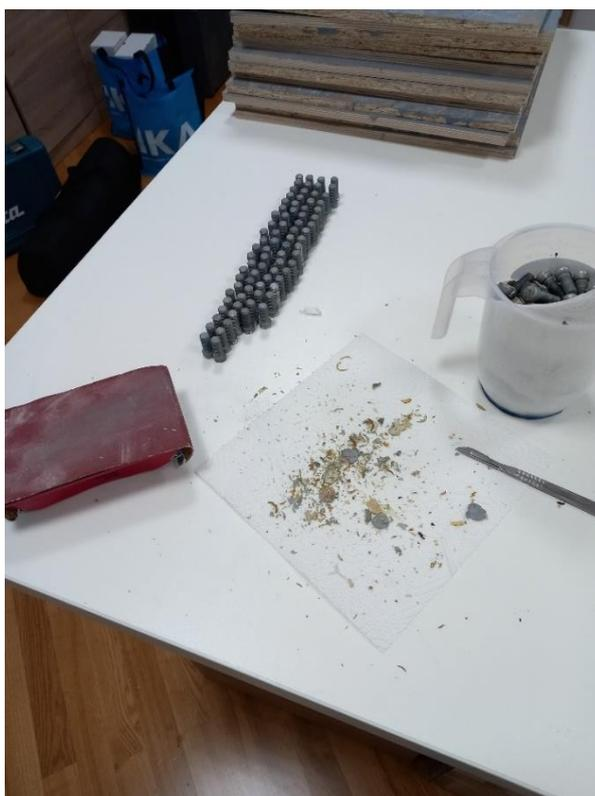
*Slika 16. Priprema valjića za lijepljenje*
