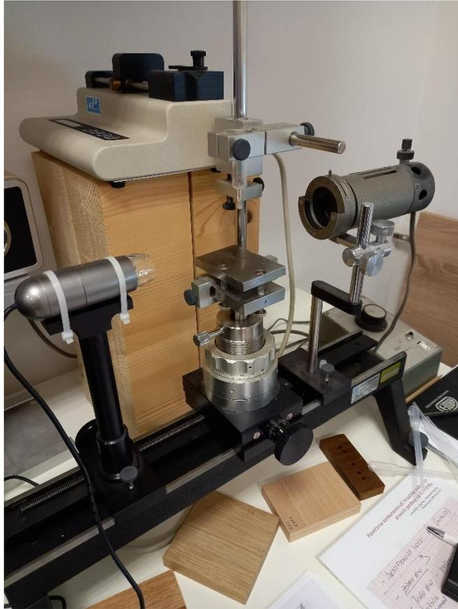
*Slika 9. Oprema za mjerenje kuta kvašenja*
