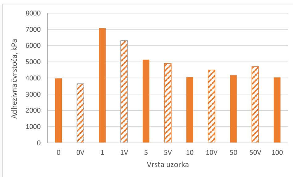
**Slika 24.** Grafički prikaz adhezijske čvrstoće vodenog laka (broj označava broj prolaza ispod UV lampe, oznaka V označava navlažene uzorke; u jednom prolazu doza zračenja iznosi  $2,36 \text{ J/cm}^2$ )
