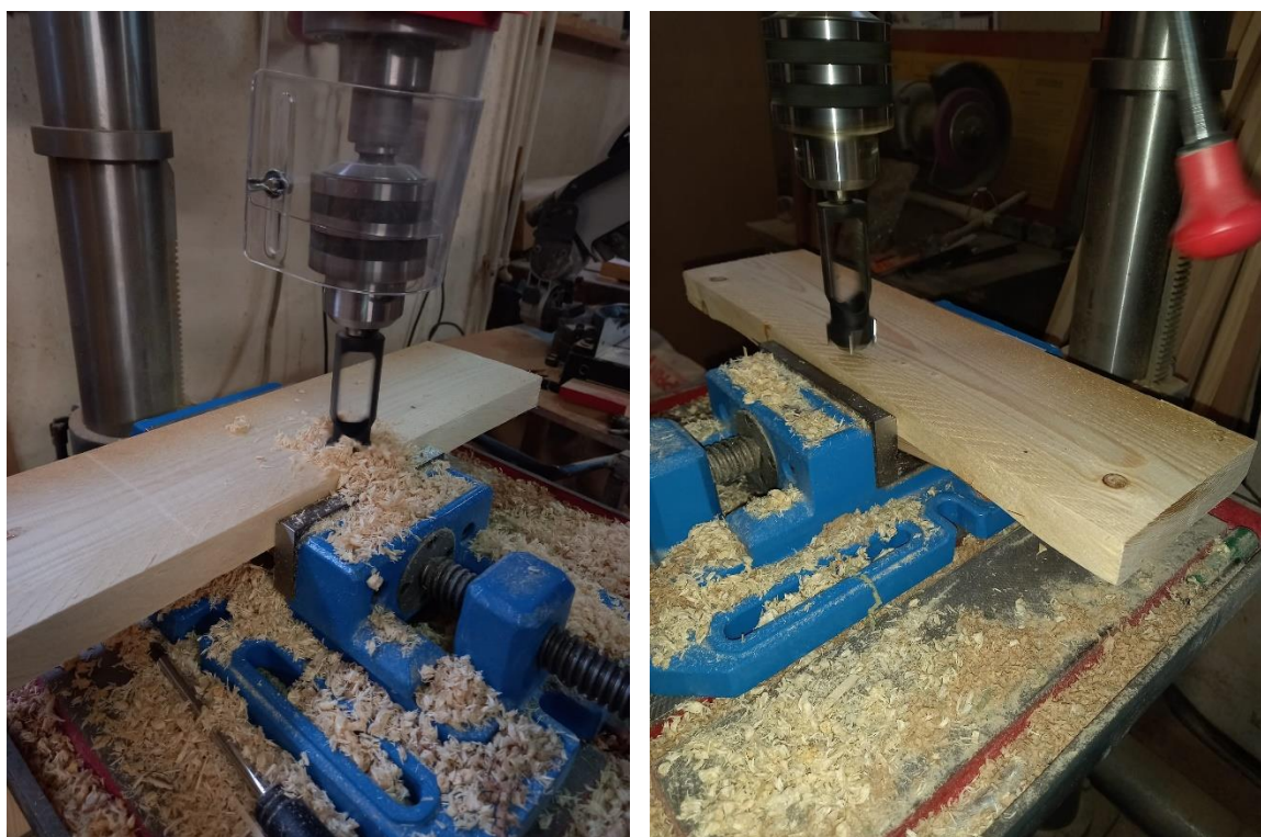
Slika 14. Izrada čepova (foto: Sabljak M.,2022)
