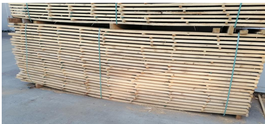
Slika 10. Nepravilan način slaganja horizontalnog razmaka špangli
