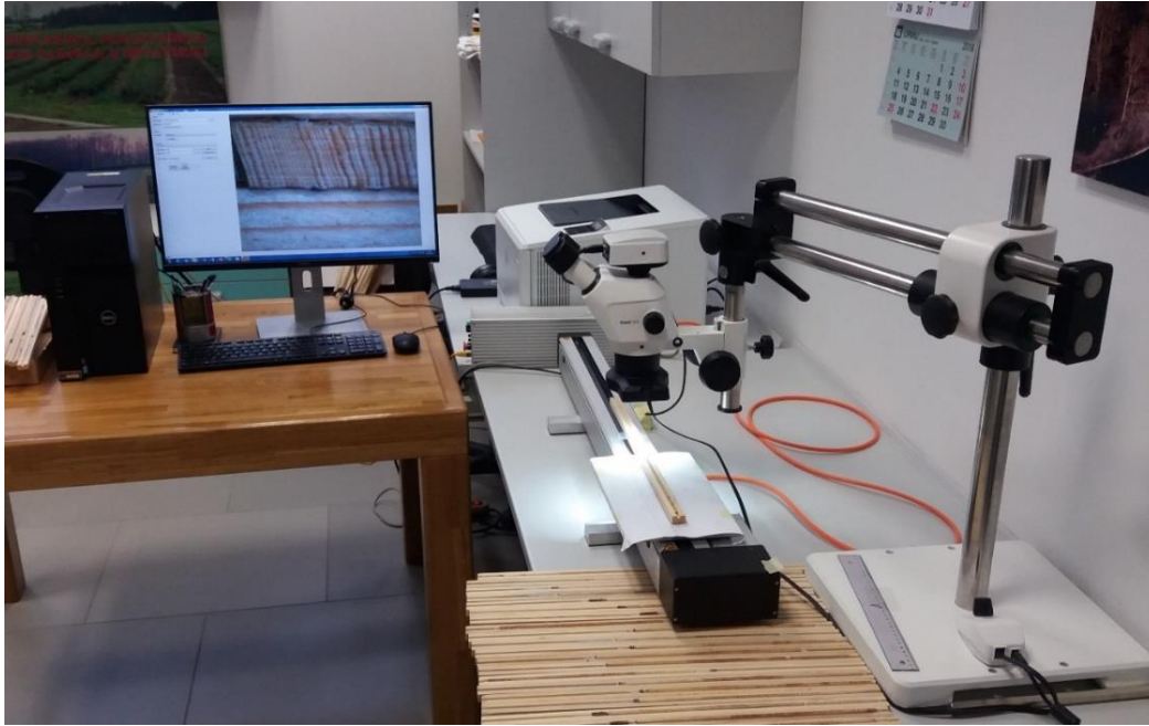
Slika 16. Snimanje izvrtaka sustavom ATRICS
