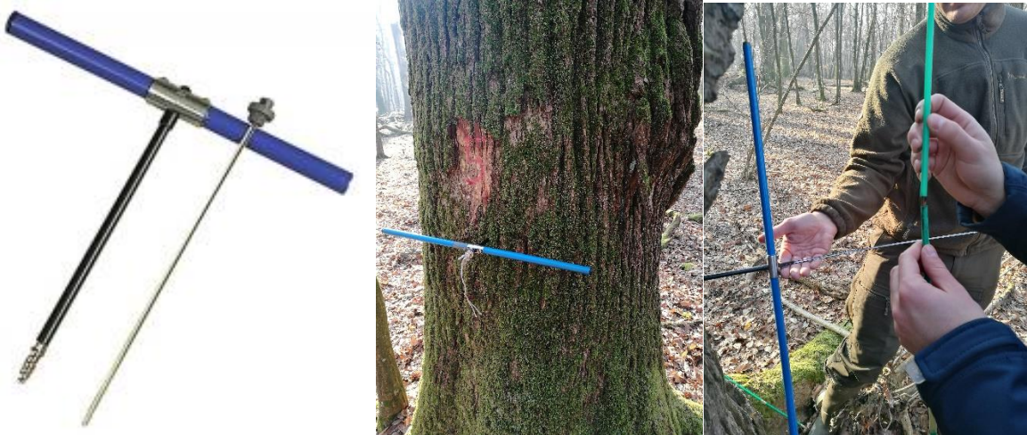
Slika 12. Presslerovo svrdlo i način uzorkovanja na pokusnoj plohi
