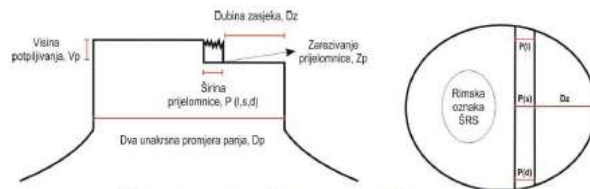
Slika 1. Mjerene vrijednosti na panju oborenog stabla
