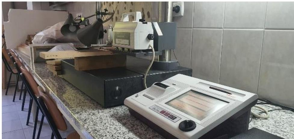
Slika 11. Mjerenje hrapavosti površine uzorka
