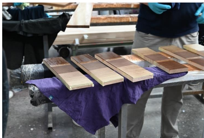
Slika 8. Nanošenje ulja na močenu površinu
