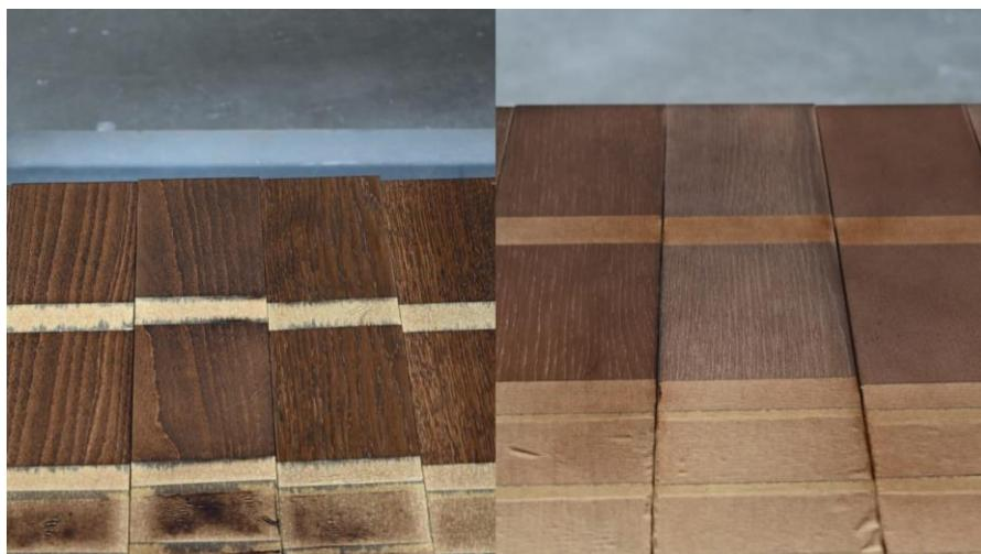
Slika 13. Lijevo: voden bajc; desno: nitro bajc
