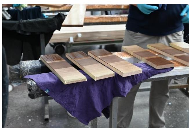
Slika 8. Nanošenje ulja na močenu površinu
