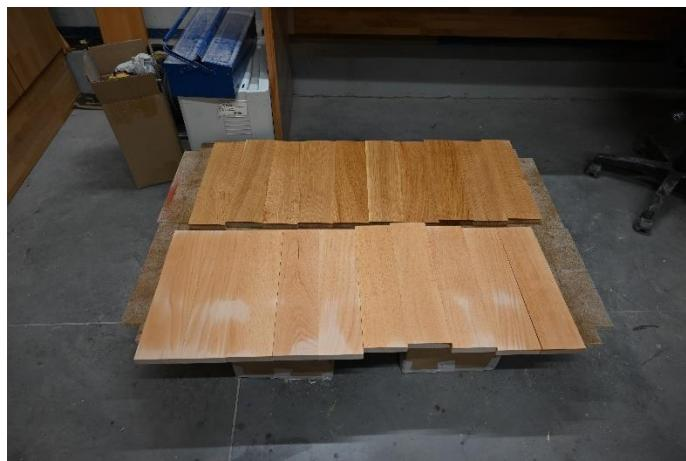
Slika 5. Navlaživanje uzorka
