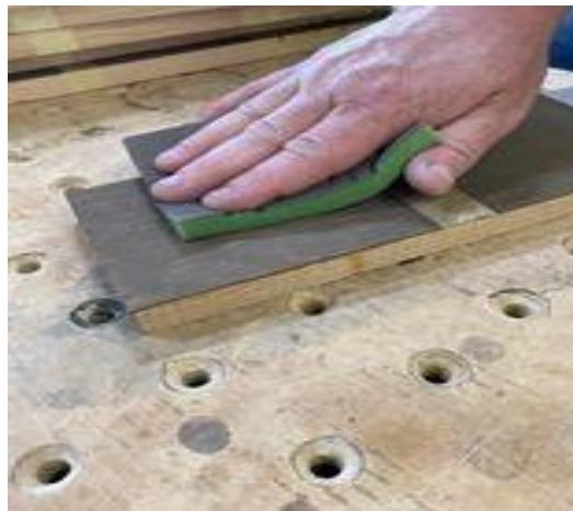
Slika 7. Brušenje močene površine brusnim papirom granulacije P280
