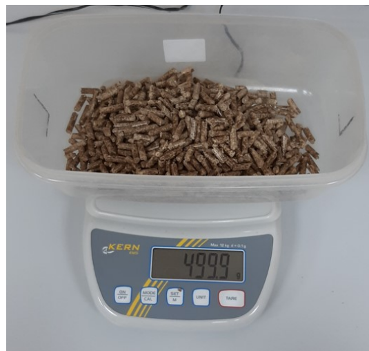
Slika 13. Vaganje prosijanih peleta
