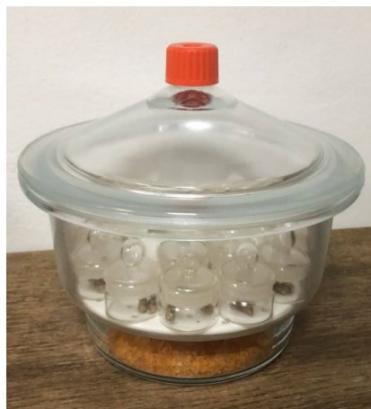
Slika 11. Uzorci u eksikatoru
