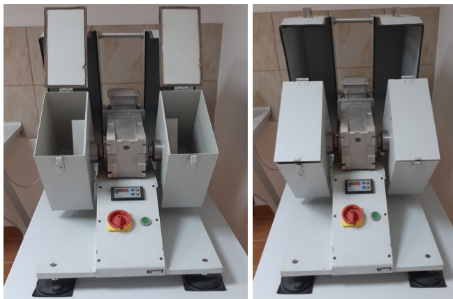
Slika 12. Uređaj za određivanje mehaničke izdržljivosti peleta (pelet-tester)
