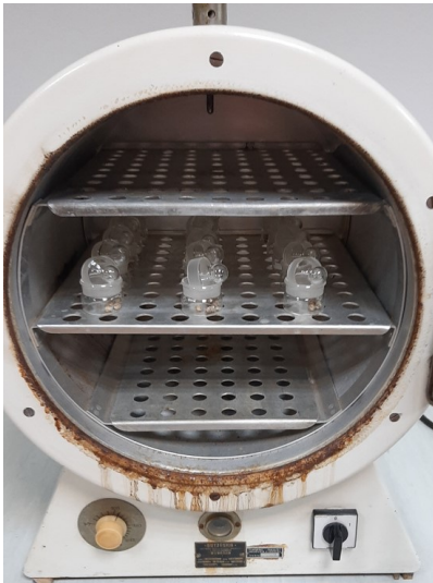
Slika 10. Uzorci u sušioniku
