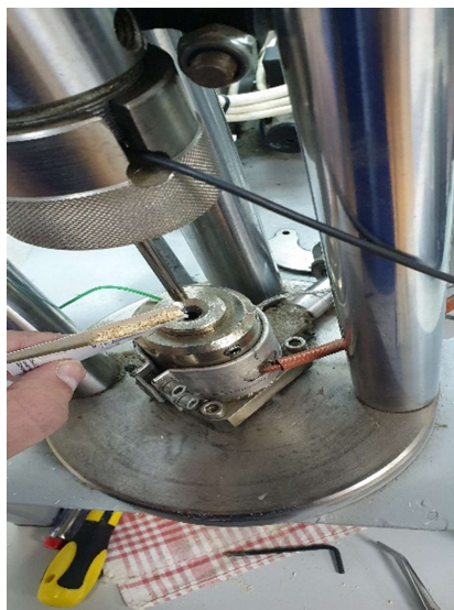
Slika 18. Punjenje matrice lijevkom
