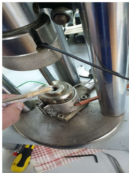
Slika 18. Punjenje matrice lijevkom
