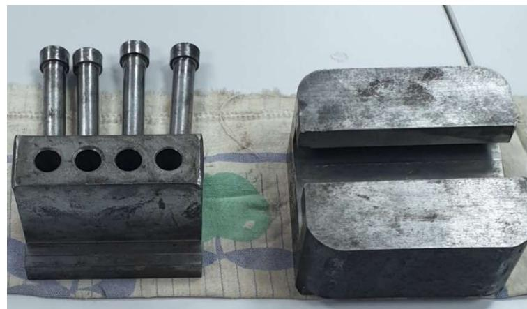
Slika 27. Kalup za prešanje tableta iz drvne sirovine
