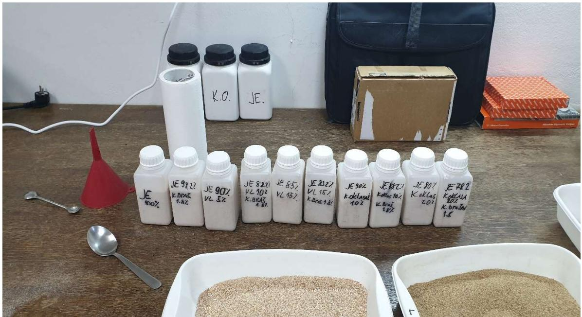
**Slika 15.** Boćice s pripremljenim uzorcima za peletiranje
