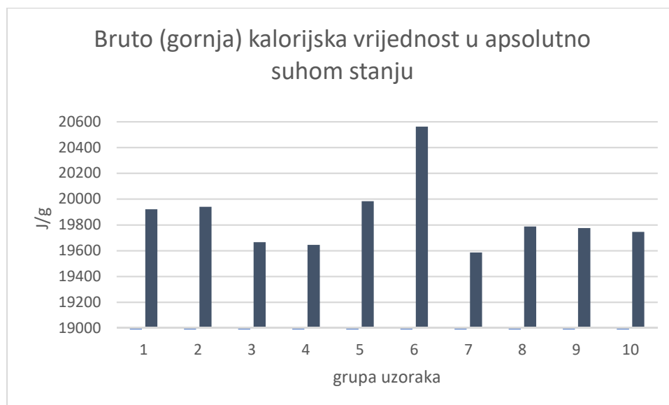
Dijagram 12. Kalorijska vrijednost peleta
