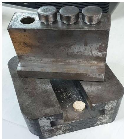
Slika 29. Isprešana tableta od drvne sirovine
