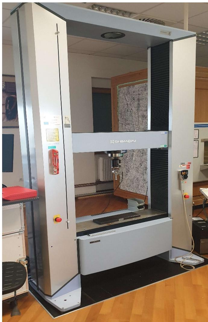
**Slika 22.** SHIMADZU kidalica
