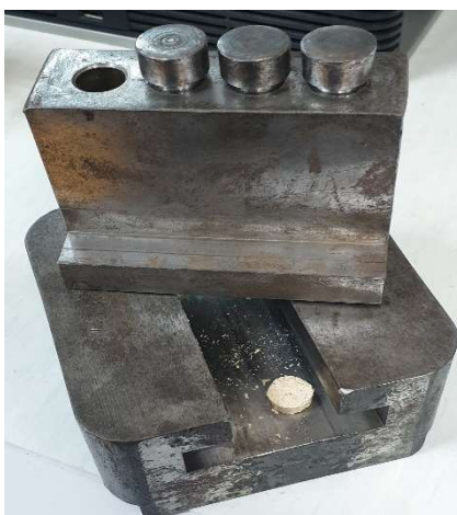
Slika 29. Isprešana tableta od drvene sirovine
