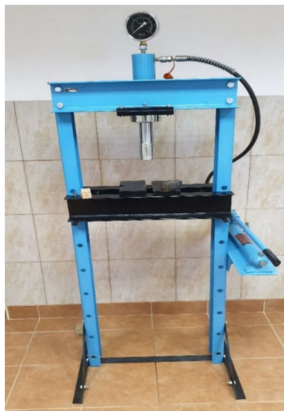
Slika 28. Hidraulična ručna preša
