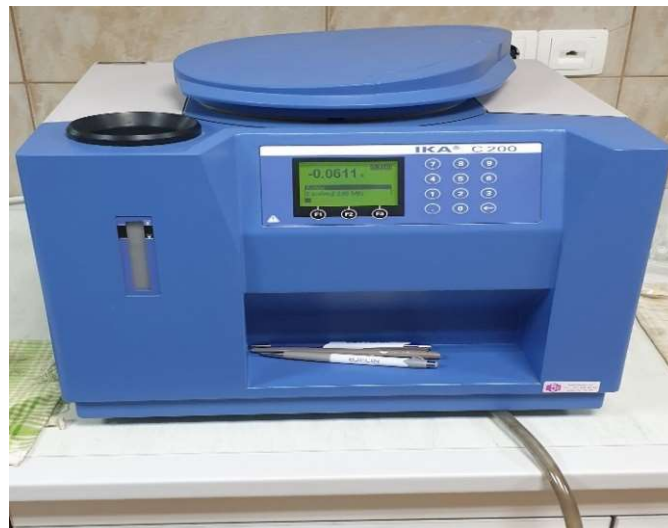
Slika 31. Kalorimetar (IKA C200)
