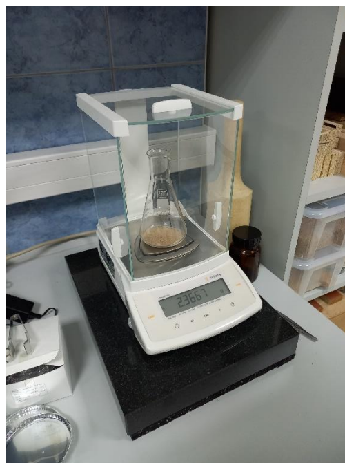
Slika 15. Vaganje uzoraka na približno 2 grama
