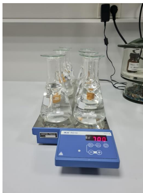
Slika 18. i slika 19. Ekstrakcija na elektromagnetskoj mješalici
