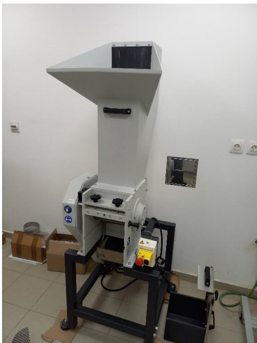
Slika 6. mlin Retsch SM400
