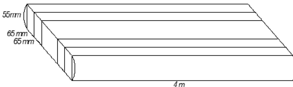
Slika 1. Shema piljenja četvrtaka i elemenata iz piljenica
