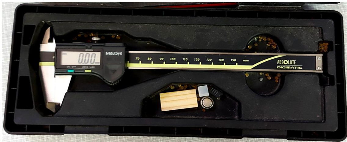
Slika 4. Digitalno pomično mjerilo sa automatskim spremanjem mjernih podataka na računalo
