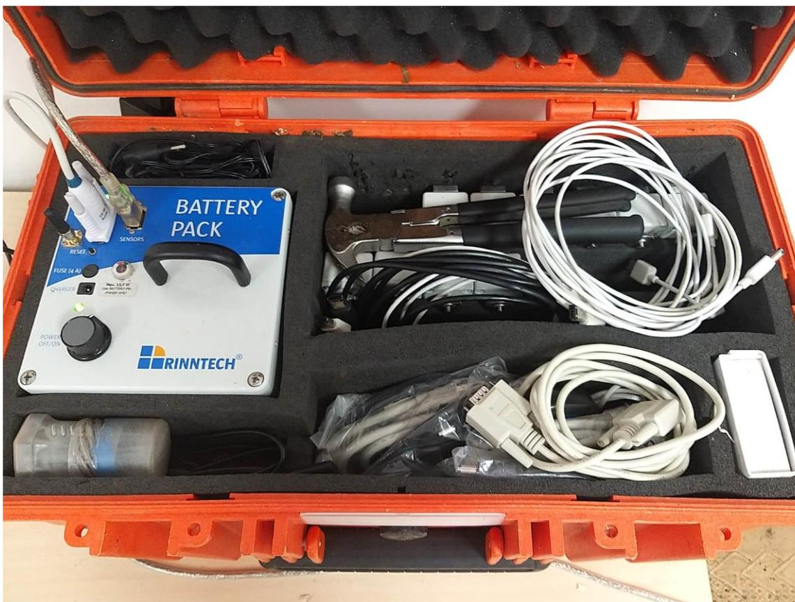
Slika 9. Zvučni tomograf RINNTECH Arbotom – Scientific 2D/3D s oprem
