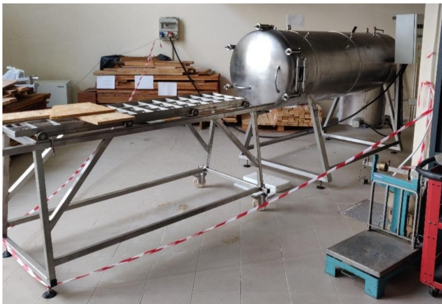
Slika 4: Kotao sa stalkom i kolicima (fotografija: Kvakon, 2022.)
