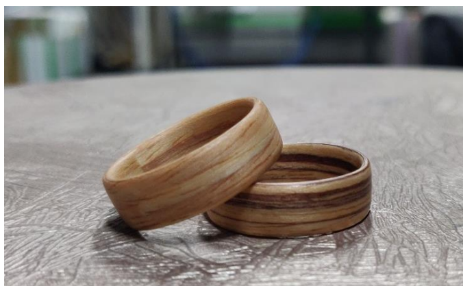
Slika 26: Primjer prstenova izrađenih od savijenog furnira (fotografija: Kvakon, 2022.)
