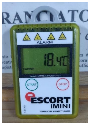
Slika 18: Termometar/vlagomjer za provjeravanje uvjeta u laboratoriju (fotografija: Kvakana, 2022.)
