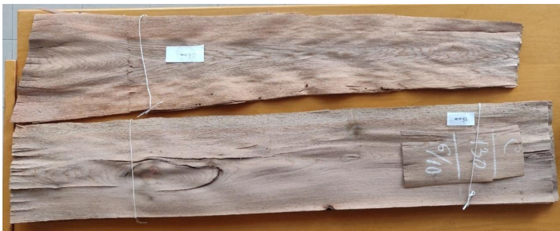
Slika 21: Svežnjevi furnira cerovine debljine 1 mm, za izradu uzoraka korišten je donji svežanj na slici (fotografija: Kvakon, 2022.)
