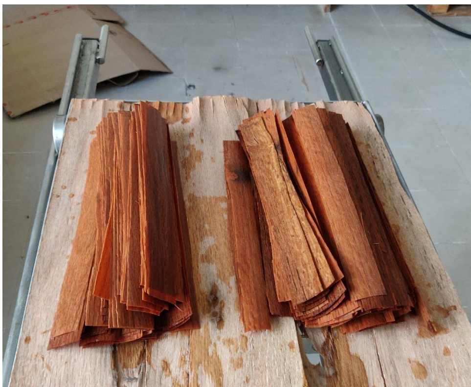
Slika 41: Dio uzoraka na kolicima odmah nakon parenja (fotografija: Kvakon, 2022.)
