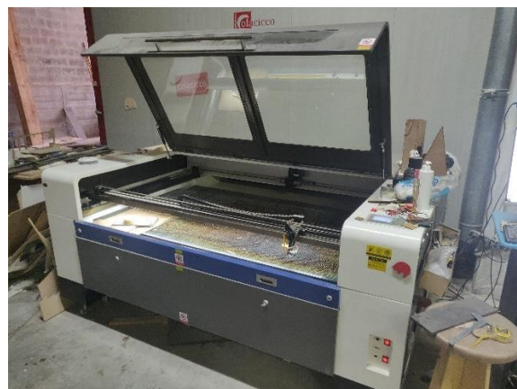
Slika 19: Laserski rezač korišten za izradu kalupa (fotografija: Kvakana, 2022.)
