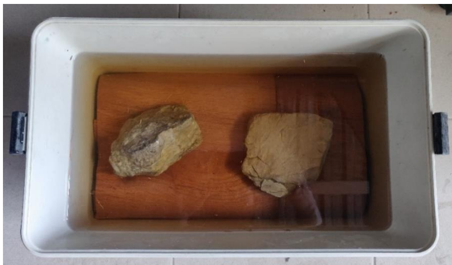
Slika 25: Namakanje uzoraka, prekriveni su listom cijelim listom furnira i opterećeni kako bi ostali ispod površine vode (fotografija: Kvakon, 2022.)
