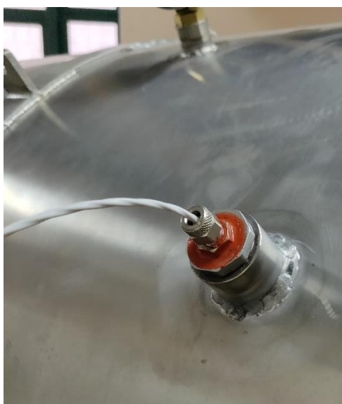
Slika 16: Ugrađen i zabrtvljen termopar (fotografija: Kvakan, 2022.)
