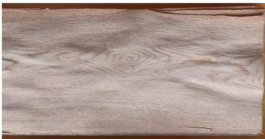
Slika 2: Površina lista furnira cerovine (fotografija: Kvakana, 2022.)
