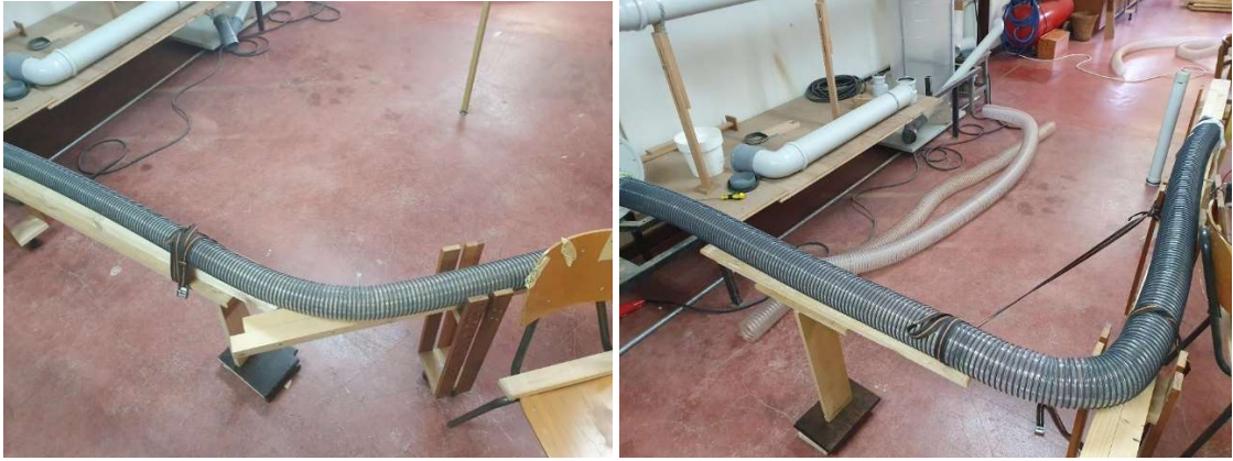
Slika 26. Prikaz cijevi postavljenih pod kutom od 45° i 90°
