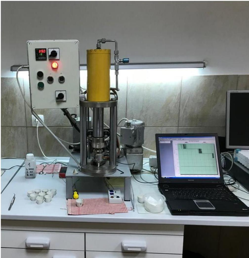
Slika 13. Preša za peletiranje
