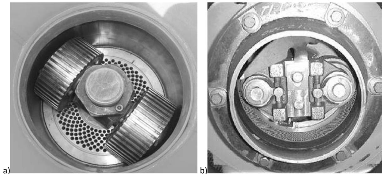
Slika 7. Konstrukcijske izvedbe preša za peletiranje
