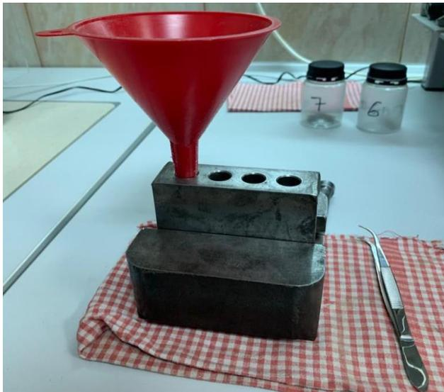
Slika 22. Čelični kalup za prešanje
