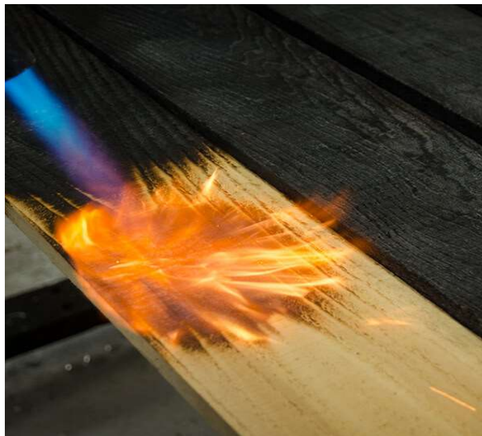
Slika 3. Zapaljivanje površine drva
