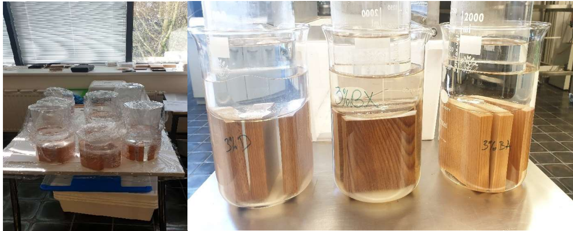
Slika 14. Kemijske komponente pripremljene kao vodene otopine u svrhu impregniranja ispitnih uzoraka za ispitivanje vatrootpornosti, tijekom i nakon procesa impregnacije
