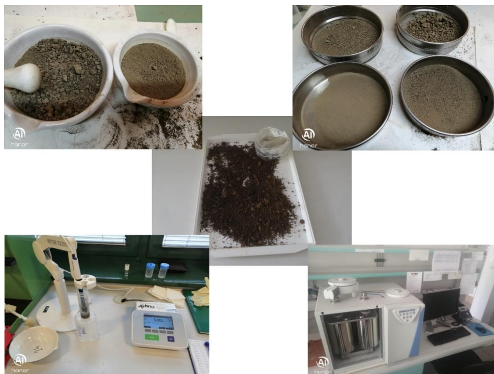
Slika 11. Priprema uzoraka i kemijske analize tla
