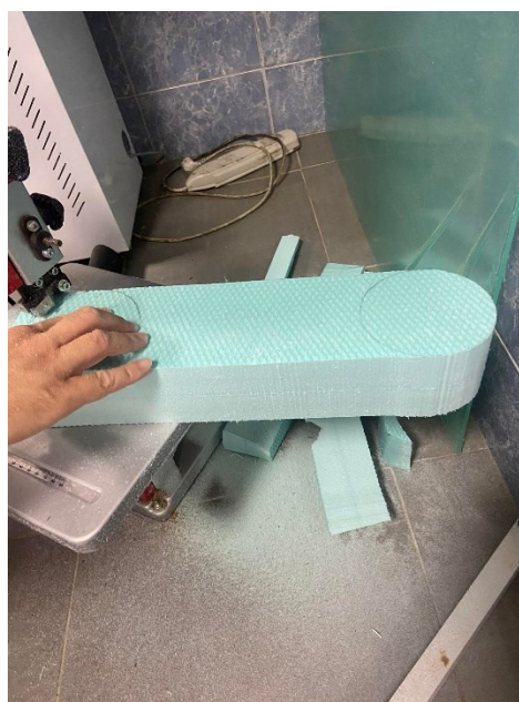
Slika 20. Prikaz piljenja šablone na tračnoj pili.
