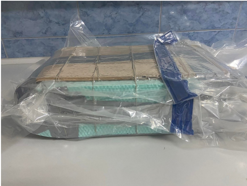
Slika 23. Prikaz vakuumiranja furnira.
