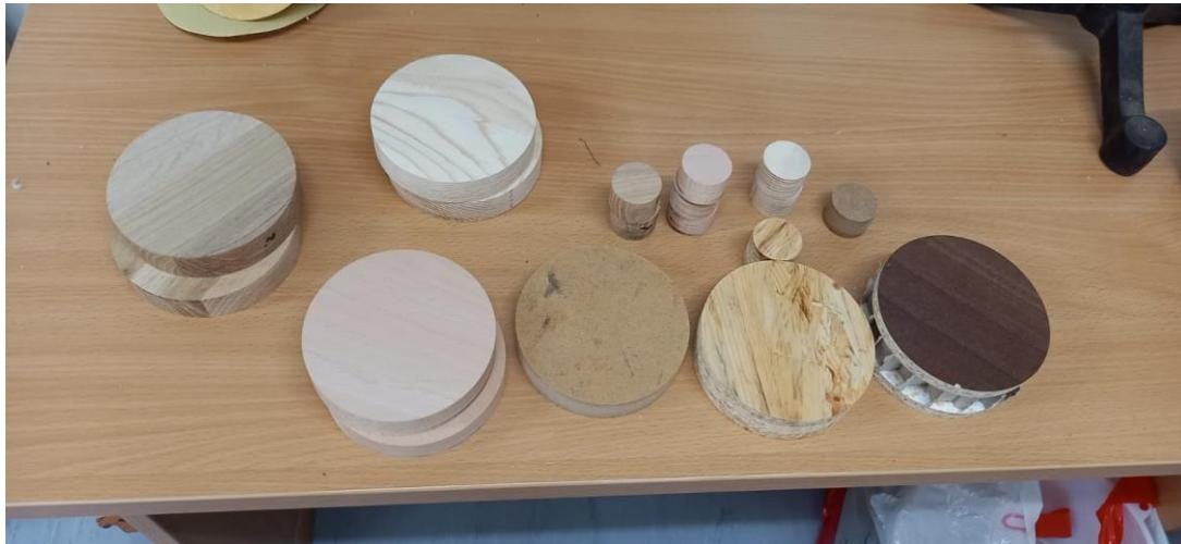
**Slika 28.** Prikaz obrađenih uzoraka prije ispitivanja
