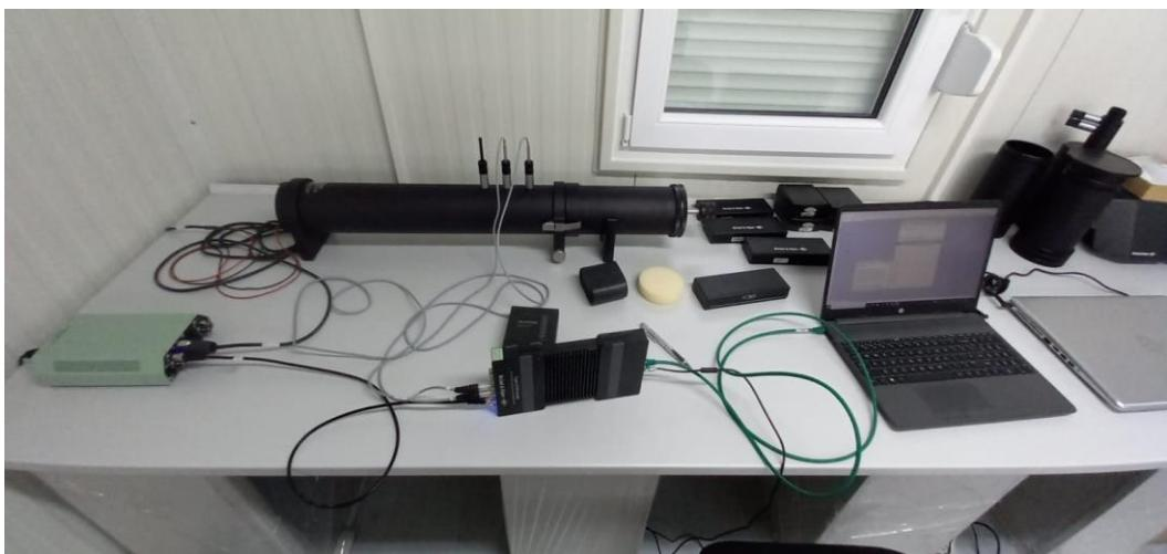
Slika 29. Impedancijski komplet cijevi
