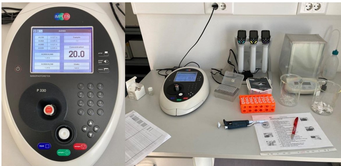
Slika 29. Određivanje koncentracije izolirane DNA na uređaju Nanophotometer P330 (Implen®).
