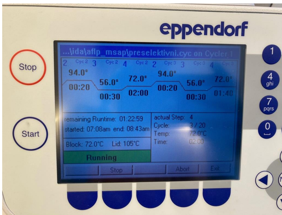
Slika 30. PCR program za preselektivnu amplifikaciju na uređaju Mastercycler EP Gradient (Eppendorf AG).
