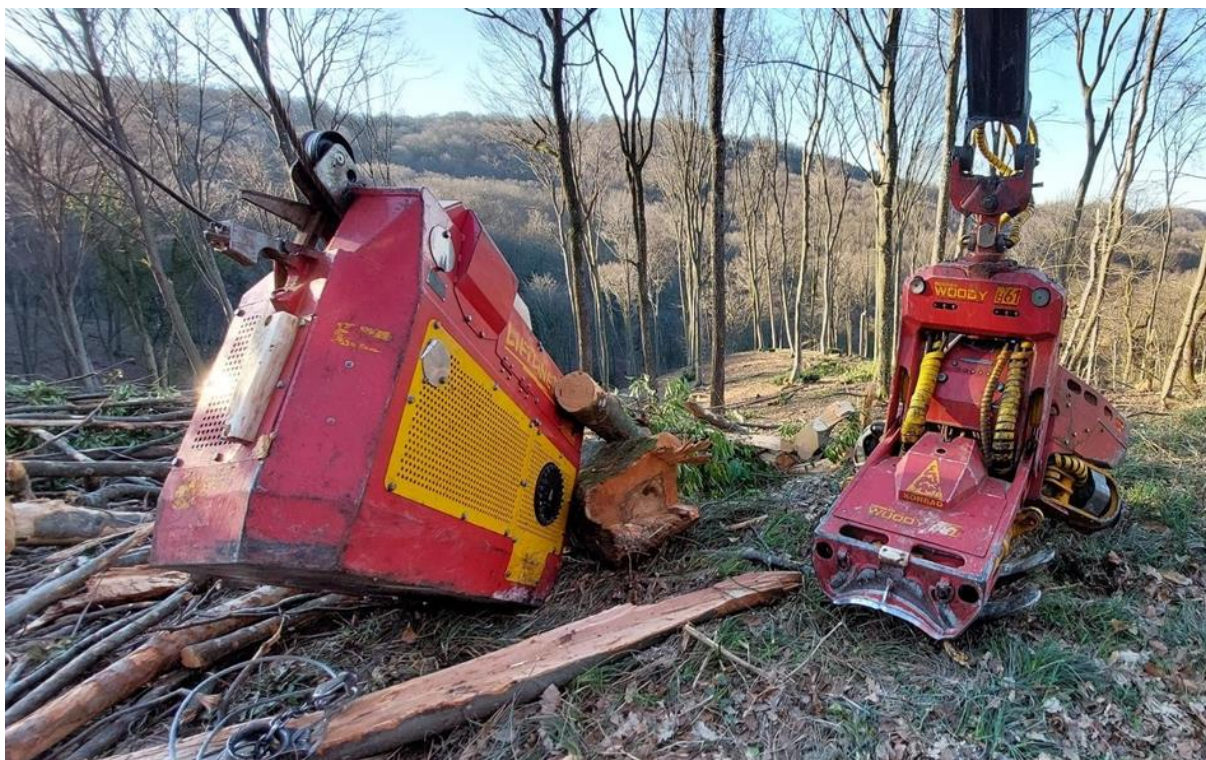
Slika 11. Prikaz kolica „Liftliner LL40-1“ i procesorske glave „Woody WH60-1“
