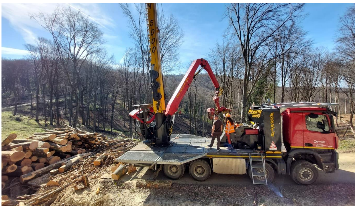
Slika 10. Stupna kamionska žičara s procesorskom glavom „MOUNTY 5000“
