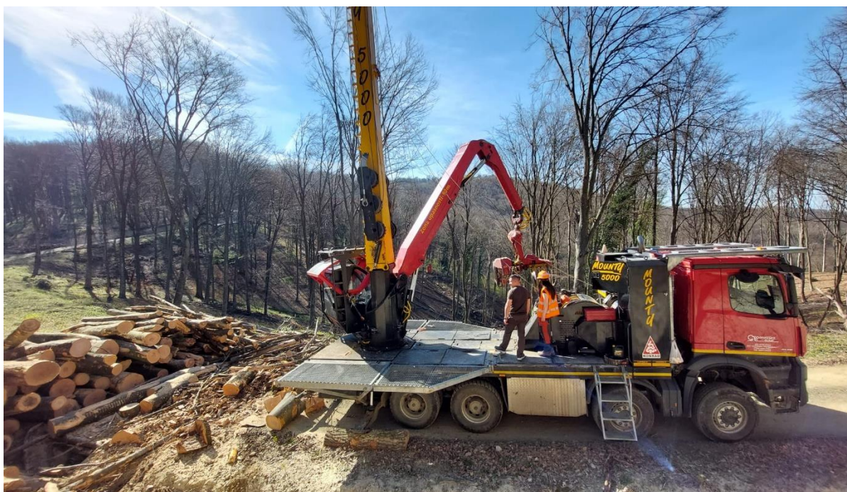
Slika 10. Stupna kamionska žičara s procesorskom glavom „MOUNTY 5000“
