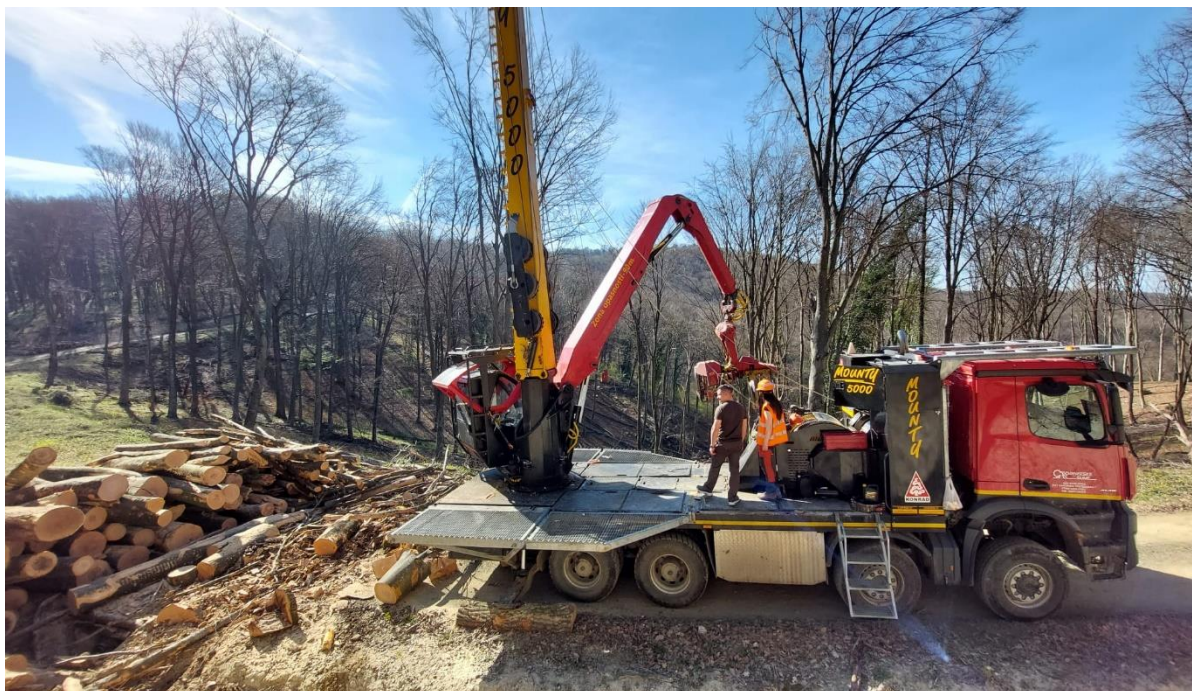
Slika 10. Stupna kamionska žičara s procesorskom glavom „MOUNTY 5000“
