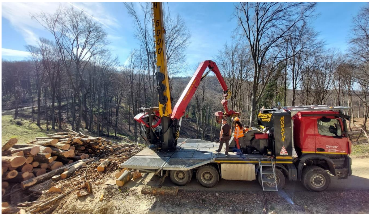
Slika 10. Stupna kamionska žičara s procesorskom glavom „MOUNTY 5000“
