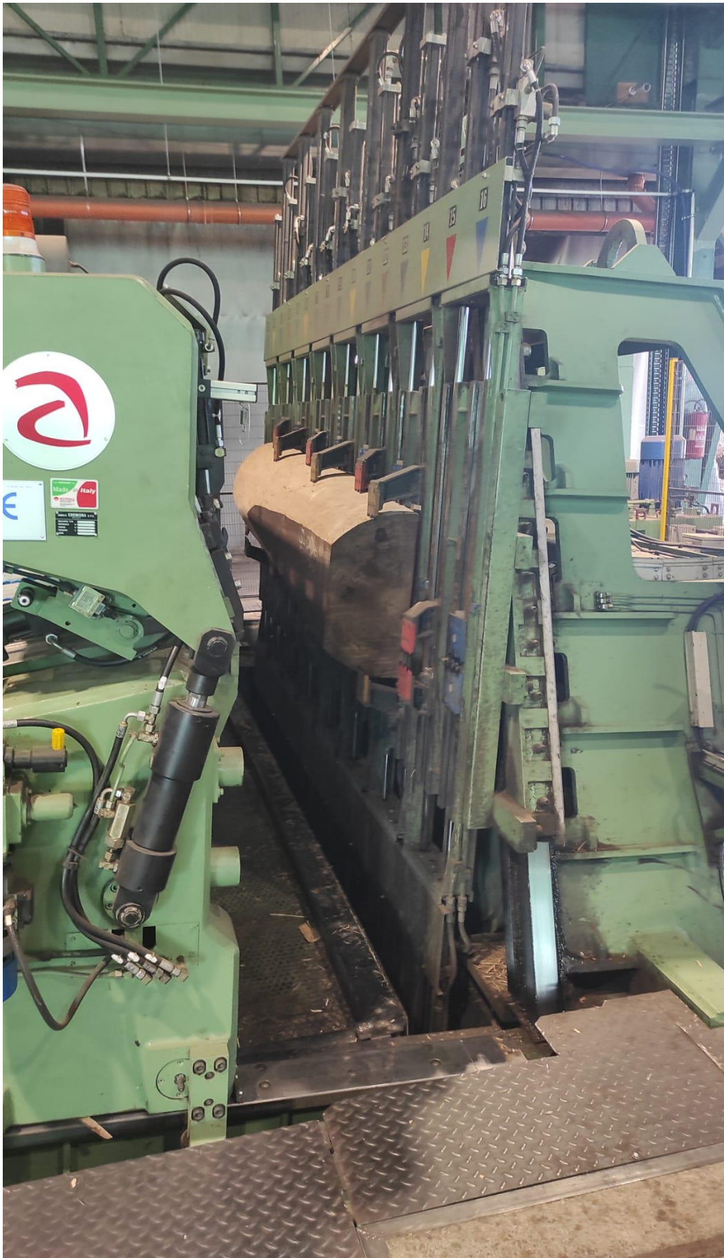
Slika 10 Polovnjak obrađivan na vertikalnom furnirskom nožu (foto: Krznarić I., 2023.)
