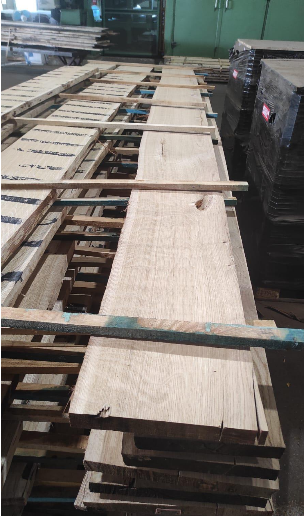
Slika 16 Ostatak Od vertikalnog furnirskog noža (trupac predhodno otvoren u trostrani vančes) (foto: Krznarić I., 2023.)
