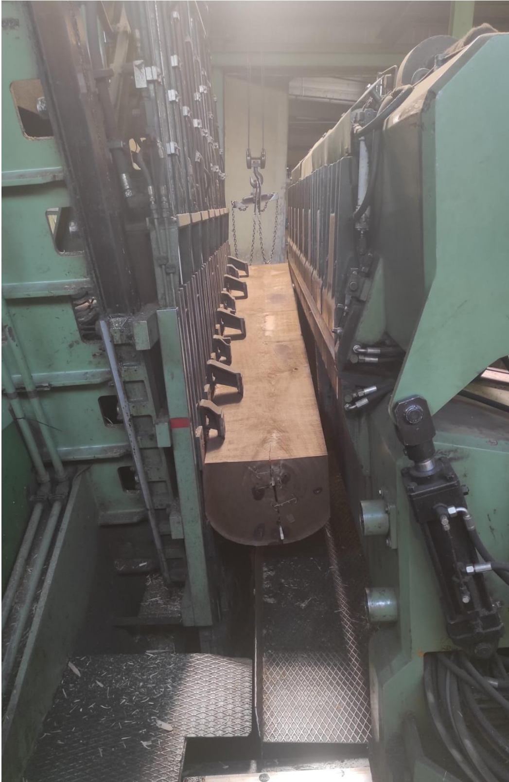
Slika 14 Obrada trupca prizmiranog u trostrani vančes na vertikalnom furnirskom nožu (foto: Krznarić I., 2023.)
