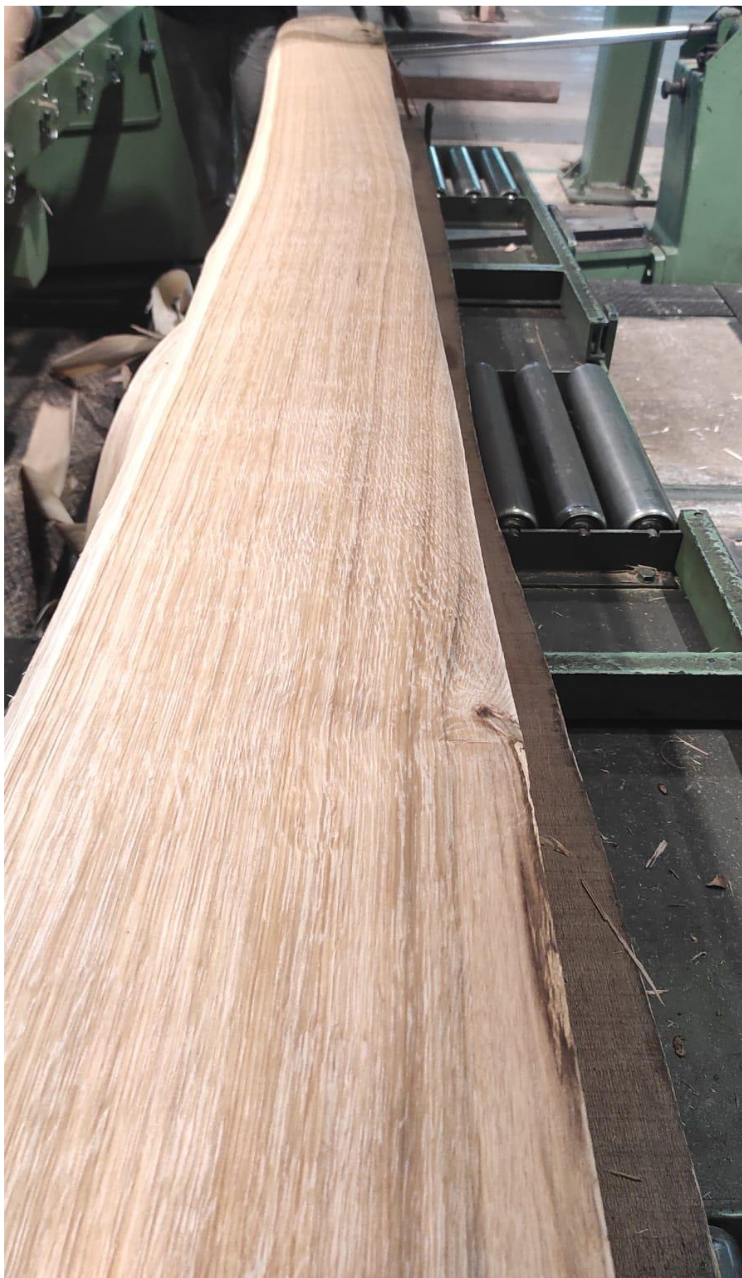
Slika 19 Listovi rezanog furnira radijalne strukture (foto: Krznarić I., 2023.)
