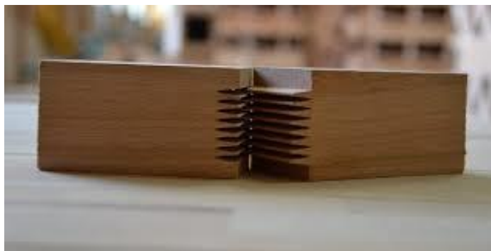
Slika 19. Dužinsko spajanje klinastim zupcima
