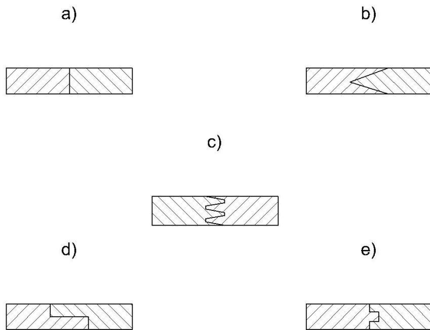
Slika 18. Vrste širinskih spojeva: a) tupi sljub, b) kosi urez, c) spoj klinastim zupcima, d) ravni preklop, e) spoj s utorom i perom.
