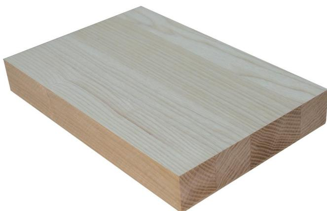
Slika 17. Ploča od širinski spojenih elemenata
