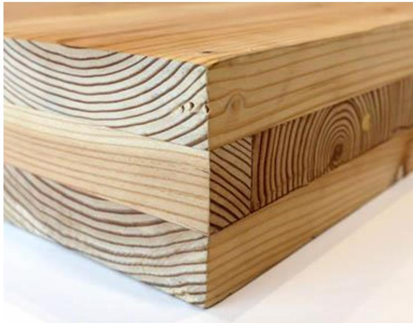
Slika21. debljinski spojeni element
