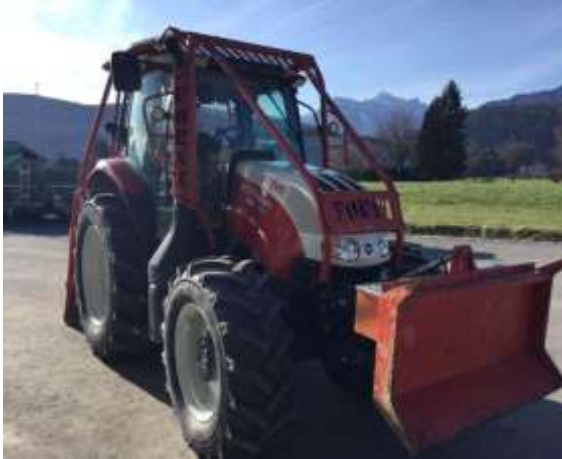
Slika 5. Adaptirani poljoprivredni traktor
