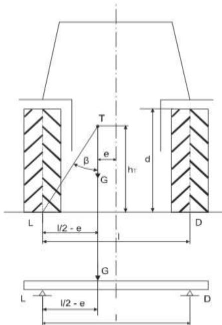
Slika 18. Kinematicka shema bočne stabilnosti traktora
