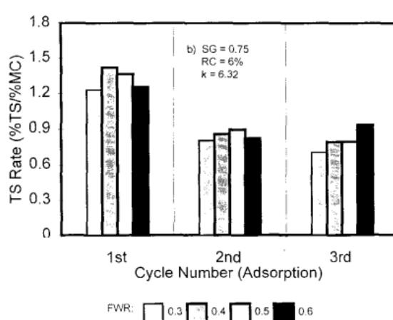
**Slika 6b.** Grafički prikaz usporedbe razine bubrenja iz tri adsorpcijska ciklusa za troslojne OSB ploče pri 6 % sadržaja smole i niskom stupnju usmjerenosti iverja
