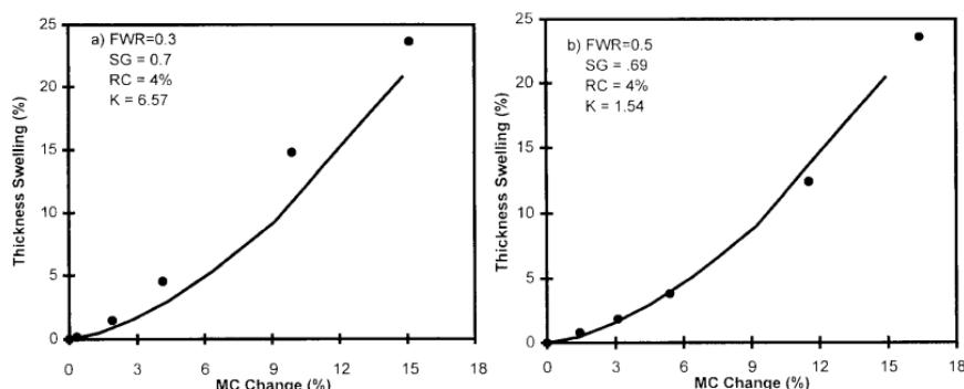
**Slika 7a.** Usporedba predviđene i izmjerene srednje vrijednosti bubrenja kao funkcije uzorka sadržaja vode za troslojne OSB ploče pri niskoj razini usmjerenosti iverja
