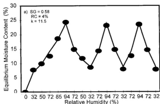
Slika 2a. Usporedba izmjerениh i predviđenih sorpcijskih izoterma pod cikličkim uvjetima za jednoslojne ploče
