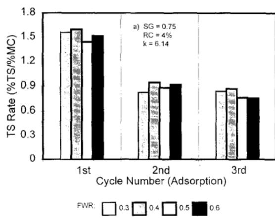
**Slika 6a.** Grafički prikaz usporedbe razine bubrenja iz tri adsorpcijska ciklusa za troslojne OSB ploče pri 4 % sadržaja smole i visokom stupnju usmjerenosti iverja
