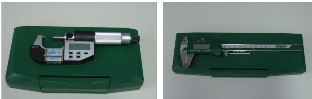
*Slika 11. Digitalni mikrometar i pomično mjerilo (Foto: Maleta, 2011.)*
