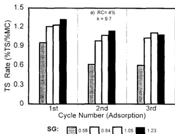
**Slika 5a.** Grafički prikaz usporedbe razine bubrenja iz tri adsorpcijska ciklusa za jednoslojne OSB ploče pri 4 % sadržaja smole i visokom stupnju usmjerenosti iverja
