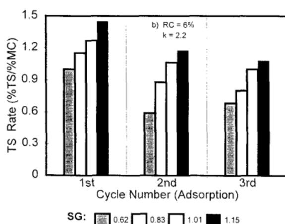
**Slika 5b.** Grafički prikaz usporedbe razine bubrenja iz tri adsorpcijska ciklusa za jednoslojne OSB ploče pri 6 % sadržaja smole i niskom stupnju usmjerenosti iverja
