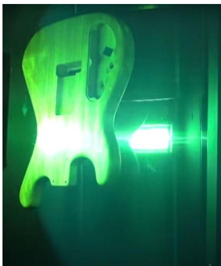
Slika 51. Poboľjšano otvrđnjivanje rubova (Cureuv.com, 2023).
