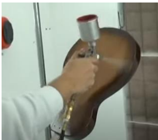
Slika 58. Nanošenje završne površine UV prskanjem (YouTube, 2013)
