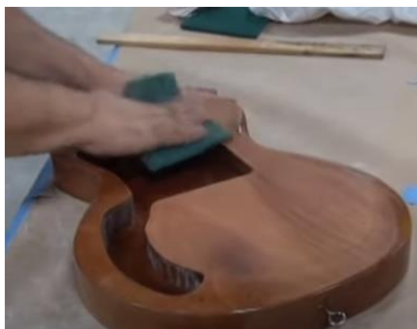
Slika 57. Brisanje drvene površine (YouTube, 2013)
