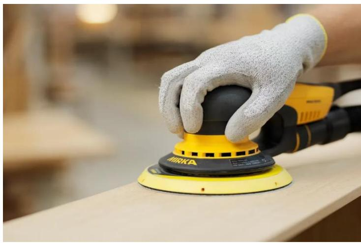
Slika 5 Ekscentrična brusilica ([www.mirka.com](http://www.mirka.com))
