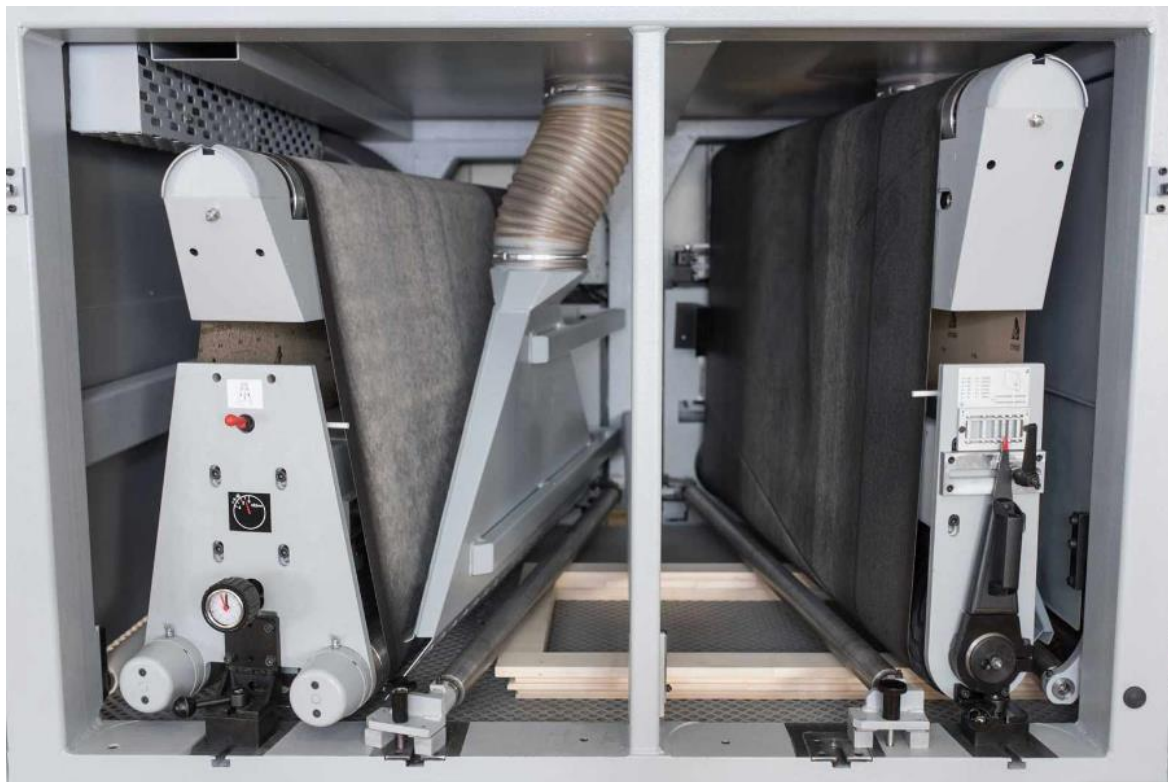
Slika 6 Širokotračna brusilica Kundig sa brusnim trakama postavljenim u "V" oblik (kundig.com)
