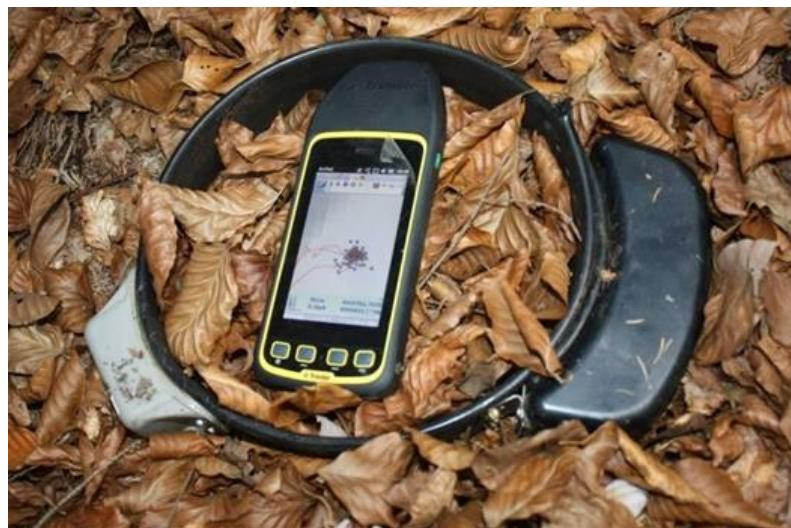
**Slika 10 – ogrlica sa ugrađenim radioodašiljačem (Huber, 2017.)**
