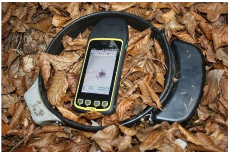
Slika 10 – ogrlica sa ugrađenim radioodašiljačem (Huber, 2017.)
